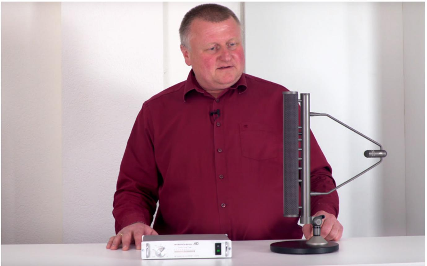
Das KEM 975 ist ein Linearray-Mikrofonsystem mit einer weitgehend frequenzunabhängigen Richtcharakteristik, die in der Horizontalebene die Eigenschaft eines Nierenmikrofons und in der Vertikalebene die eines Richtmikrofons mit einem Öffnungswinkel von ca. 30 Grad aufweist. Aufgrund dieser besonderen Aufnahmecharakteristik eignet sich das KEM 975 für Chor- und Orchesteraufzeichnungen sowie als Sprechermikrofon in Hörsälen und Konferenzräumen.
