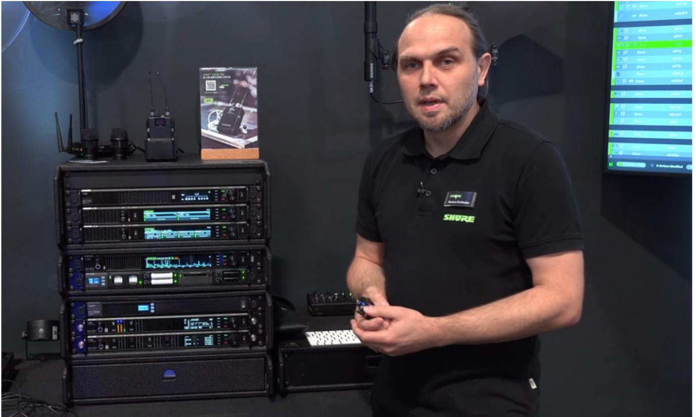
Markus Eichhofer von Shure stellt auf der LEaT con 2024 in Hamburg das neue Shure AXIENT DIGITAL PSM Wireless Monitor System vor, das verschiedenste Modulationsverfahren unterstützt und zwar von analogem FM bis zum digitalen mehrkanaligem WMAS.
