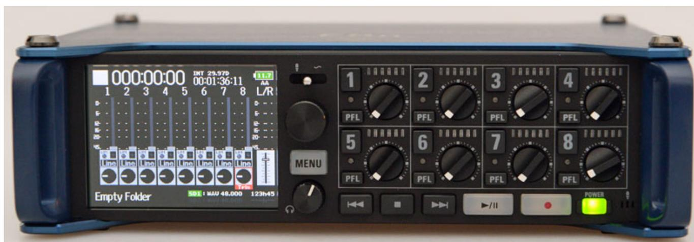
Weiterer Vorteil, ist, dass beim F8n sich die Remote FRC-8 nun vom F8n aus speisen lässt und man benötigt dafür also keine extra Spannungsversorgung oder eingelegte Batterien im FRC-8.
