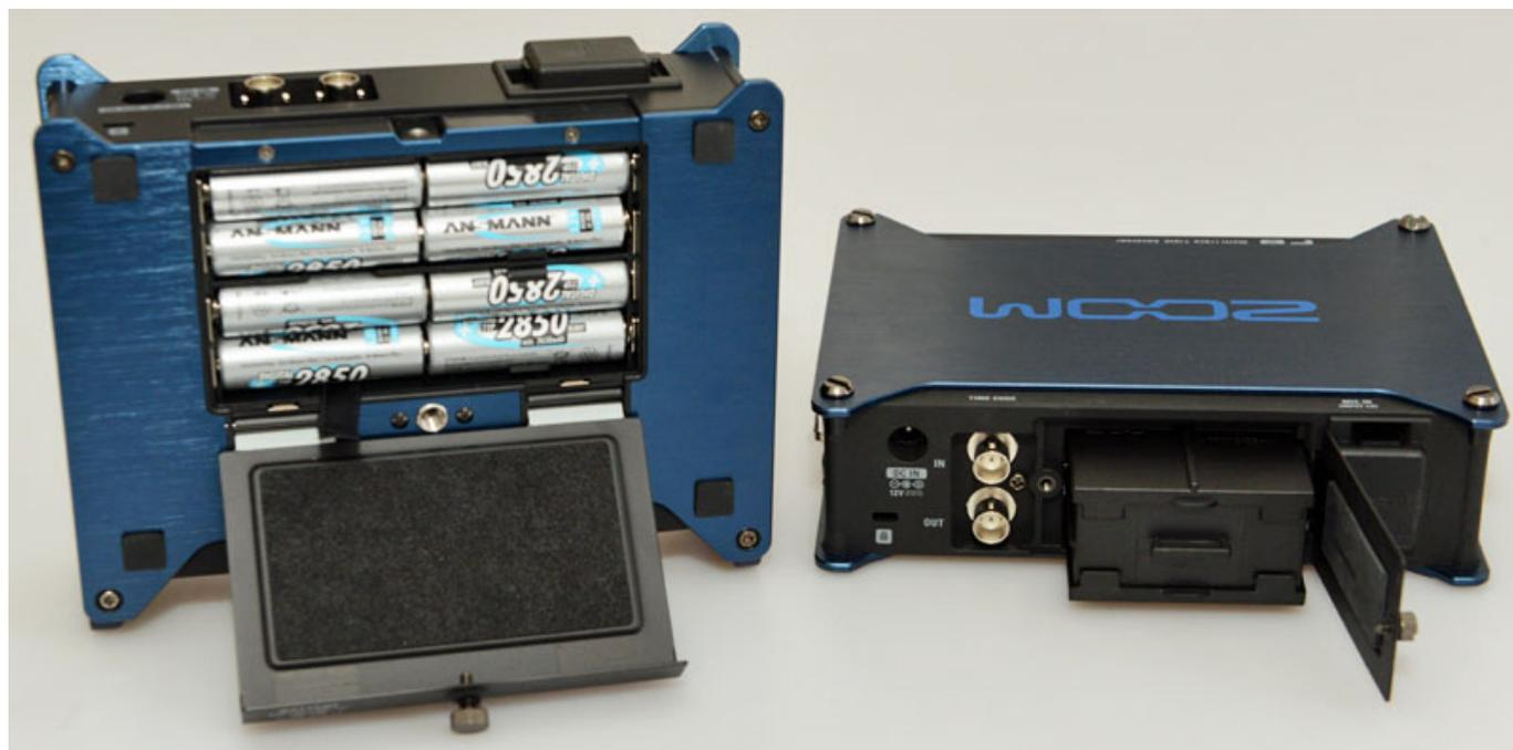
Im Gegensatz zum F8 verfügt der F8n nicht über einen Batteriemagazin, das aufgefüllt und eingeschoben werden kann, sondern direkt über ein Batteriefach (Abb. oben, F8n linke Seite), in dem Batterien in AA-Größe direkt eingelegt werden können. Auch NiMH-Akkus mit größerer Kapazität, die meistens auch von den
