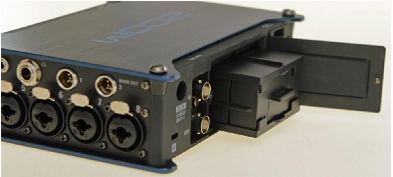
Eine weitere Möglichkeit ist die Speisung über das mitgeliefertes Steckernetzteil (100 ... 240 V, 50/60 Hz). Der Stecker ist eingerastet und ist daher vor versehentliches herausziehen gesichert. Weiter gibt es an der linken Seite eine HIROSE 4-Pin-Buchse für eine externe Versorgung mit neun bis 16 Volt Gleichspannung.
