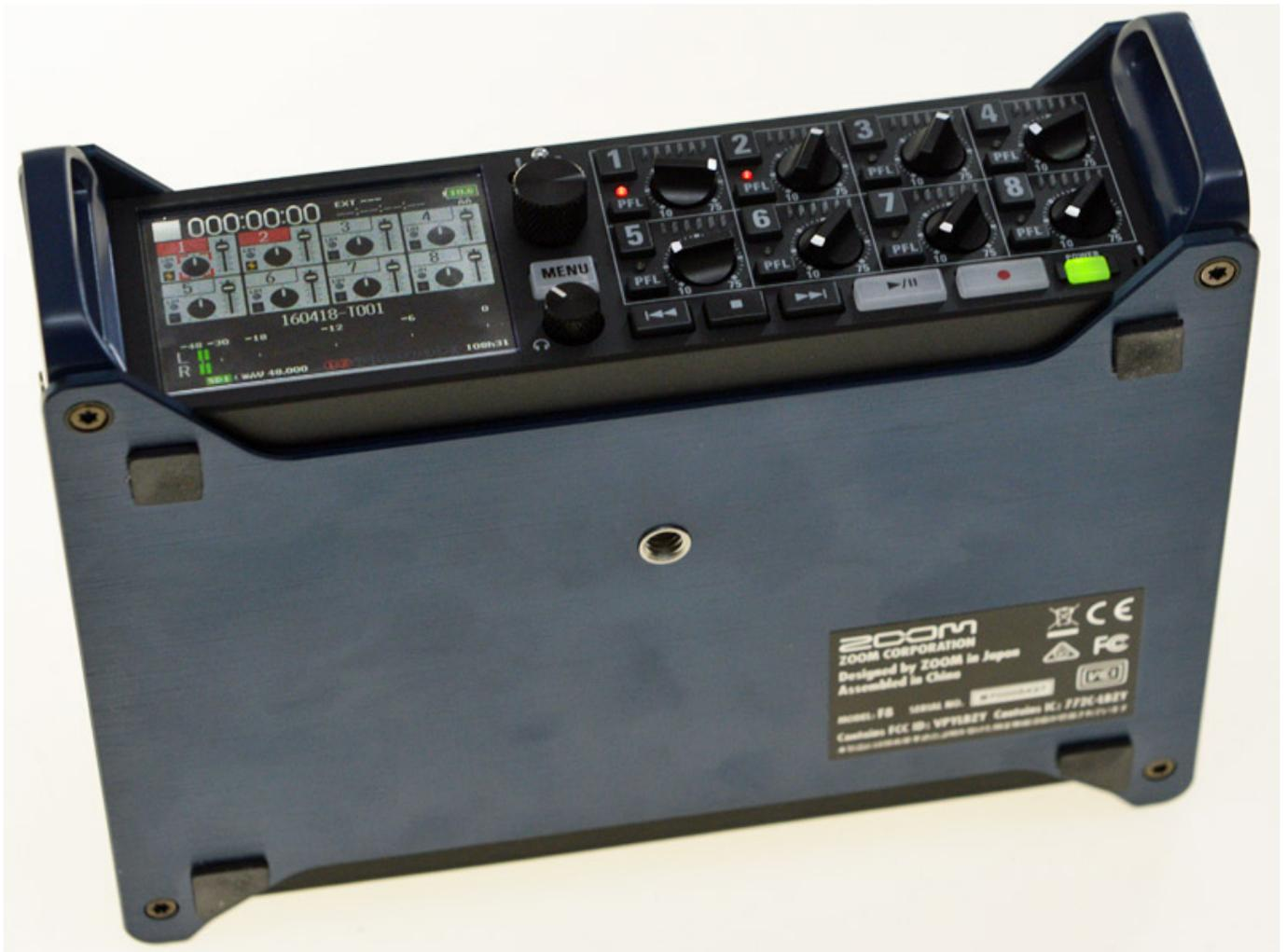
Der F8 Recorder lässt sich auch hochkant aufstellen (s. Foto oben) wenn kein Steckernetzteil benutzt und wenn keine Timecode-Buchse belegt wird.
