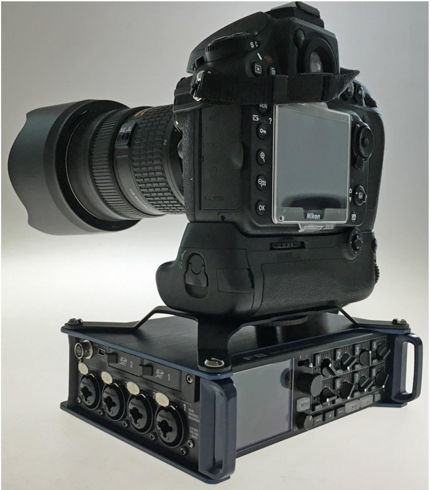
Es gibt beim F8 drei Möglichkeiten der Spannungsversorgung. So z. B. über acht Alkaline- oder Lithium-Batterien oder NiMH-Akkus in Größe Mignon (AA Size), die in ein Batteriekasten eingelegt werden. Der Batteriekasten wird auf der Geräterückseite eingeschoben. Die Abdeckung ist über eine Schraube fixiert aber schnell zugänglich, so dass man mit einem zweiten vorbestückten Batteriekasten,
