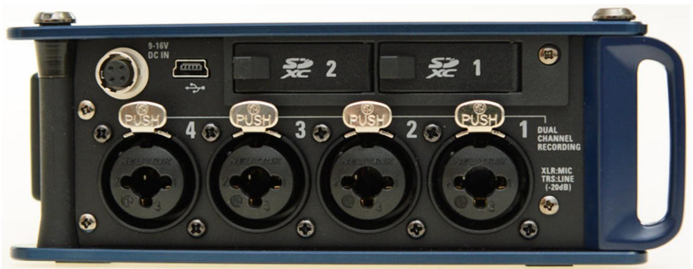
Auf der linken Seite befindet sich noch eine Micro-USB-2.0-Buchse sowie zwei Slots für SD-Karten. Bei einem Anschluss via USB an einen Rechner lässt sich auch ohne Card Reader auf den Inhalt der beiden SD-Karten zugreifen. Diese erscheinen dann als externe Medien auf dem Desktop.
