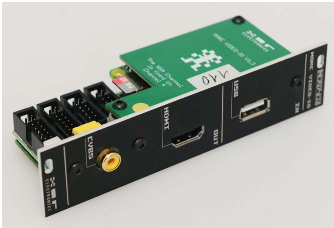
Ein relativ neues Modul ist das Video-Modul, das gleich verschiedenste Funktionalitäten bietet. Angeschlossen wird er am NSA- sowie am MIDI-Bus. Es ist aber trotzdem weiter der Betrieb eines MIDI-Expanders wie gewohnt möglich. Der Video-Expander taucht im System fest als NSA Slot 4 auf. Das Modul muss auch an den MIDI-Bus angeschlossen werden. Die Kabel für die Verbindung liegen dem Modul natürlich bei.
