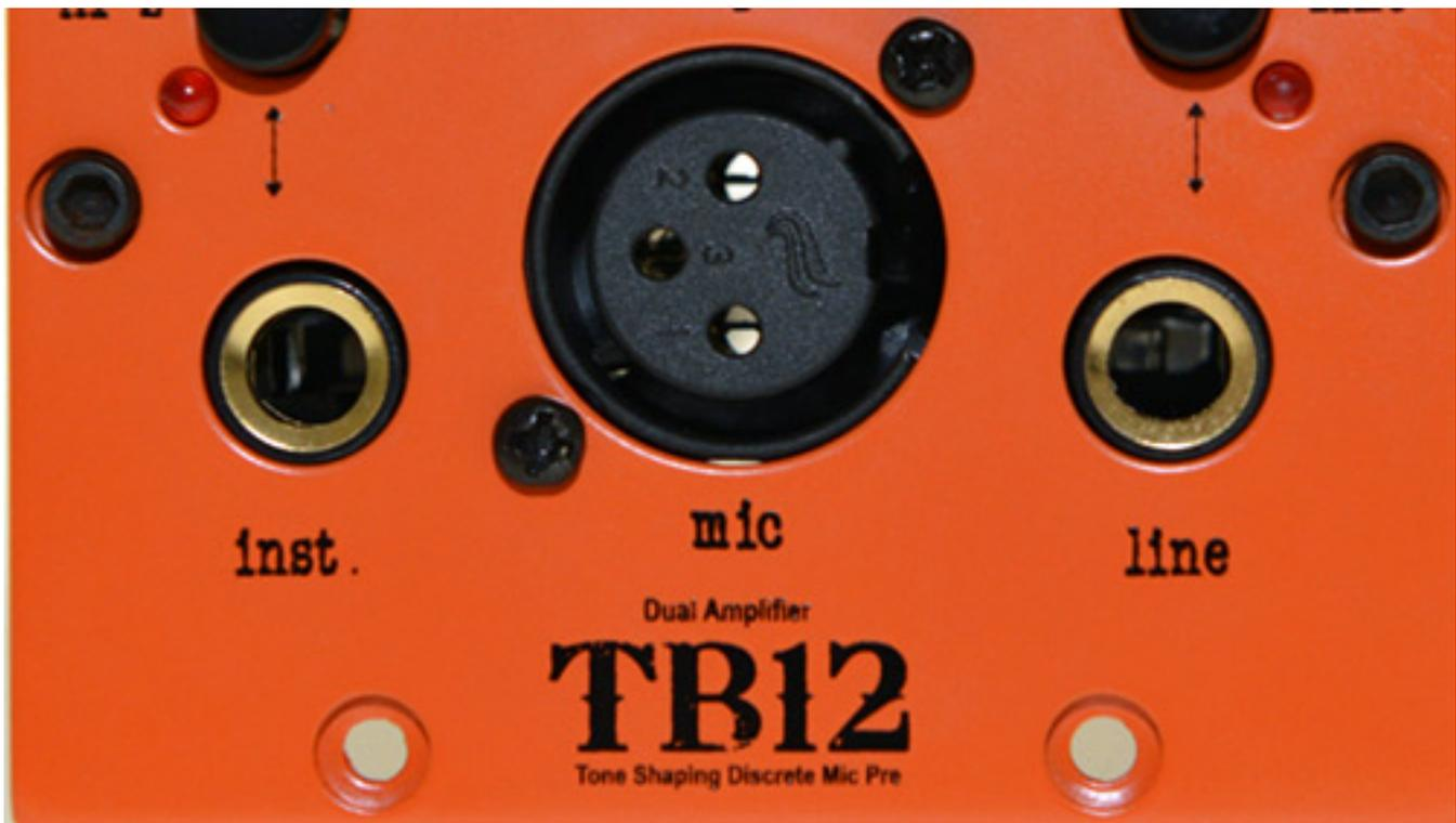
Auch bei den Anschlüssen bietet der TB12 einiges den es gibt auch Anschlüsse auf der Front. Neben einer XLR-Mikrofoneingangsbuchse (XLR) gibt es dort noch zwei 6,3-mm-Klinkensteckerbuchsen für einen Line-Pegel-Eingang und einen hochohmigen Instrumenteneingang (s. Abb. oben). Natürlich besitzt ein Preamp in dieser Klasse auch eine zuschaltbare 48-Volt-Phantomspannung auf der Mikrofoneingangsbuchse.
