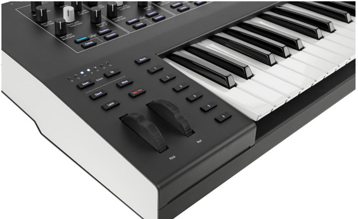
Dafür gibt es Pitch- und Modulations-Räder sowie sechs belegbare Funktionstasten (s. Abb. oben) bei der Keyboard-Version.
