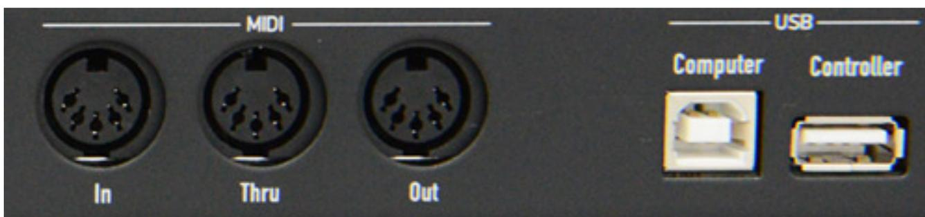
Der Iridium verfügt sowohl über MIDI In, Thru und Out als auch über USB-Anschlüsse für eine DAW oder einen Controller (s. Abb. oben).
