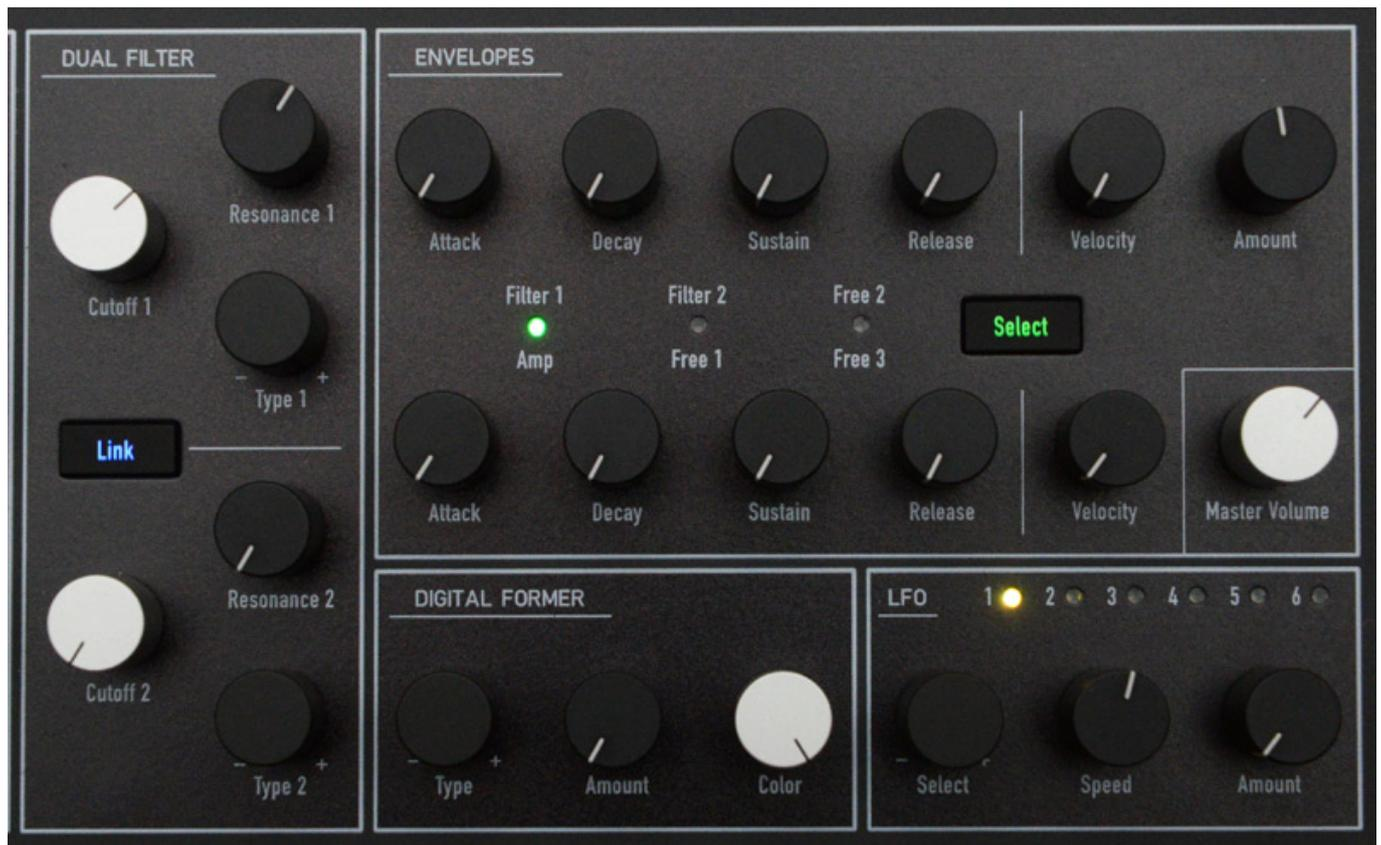
Der Iridium verfügt über zwei steuerbare Dual-Filter. Die wichtigsten Parameter wie Filtertyp, Grenzfrequenz und Resonanz lassen sich direkt über Drehgeber einstellen (s. Abb. oben). Über den Taster "Link" lassen sich die Verschaltungen der Filter ändern. Im Filter-Dialog kann der Anwender auch das simulierte Filtermodell einstellen. Hier gibt es auch die digitale Simulation der analogen Quantum-Filter sowie Filter des Largo, Nave und der PPG Wave sowie ein Model für State-Variable-Filter.
