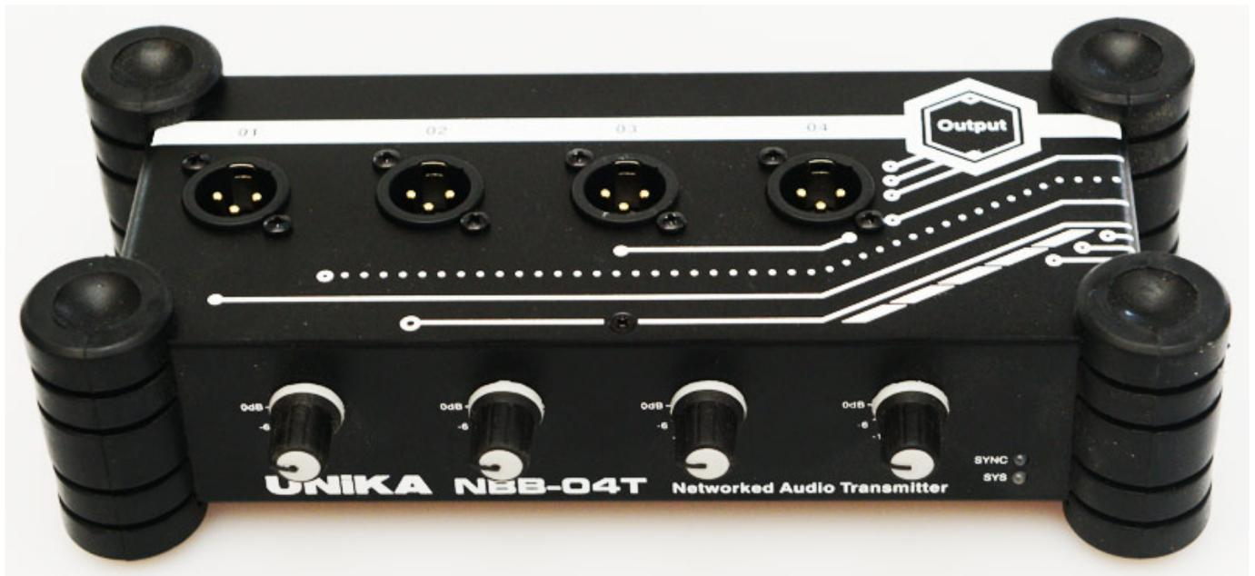
Das Konzept und Design vom Sender und Empfänger sind fast identisch. Die analogen Eingänge beim Sender verfügen zusätzlich über eine zuschaltbare 48-Volt-Phantomspannung und die XLR-Buchsen sind natürlich entsprechend unterschiedlich, das heißt XLR-3-M-Buchsen beim Sender und Kombibuchsen XLR-3-F/6,3-mm-Klinke beim Empfänger.
