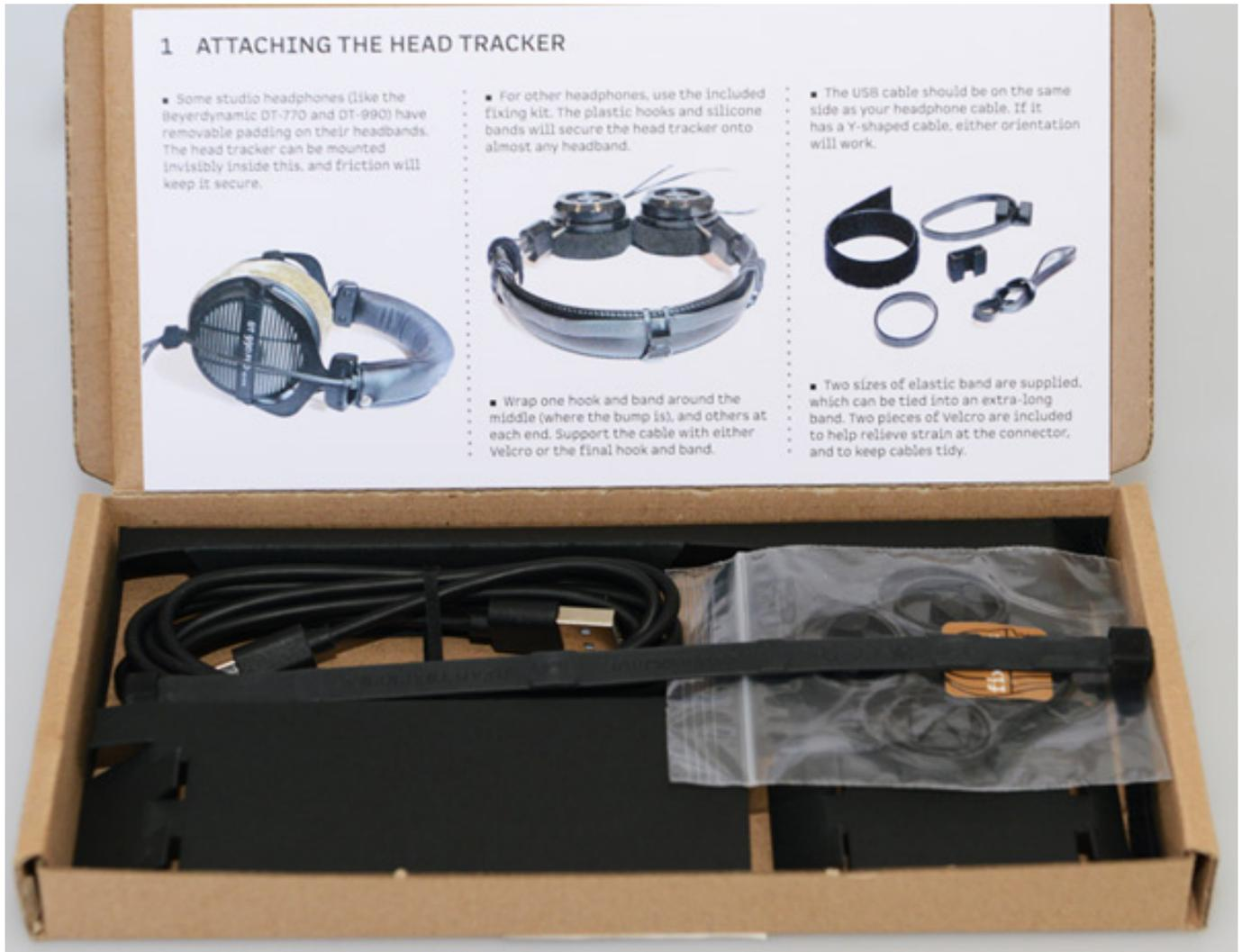
Kommen wir aber nun erstmal zum Produkt. Geliefert wird der Head Tracker 1 mit einer Kurzanleitung, einem USB-Kabel sowie Befestigungsmaterial in Form von acht Gummibänder in zwei Größen mit vier Kunststoff-Clips für die Gummibänder für die Headtracker-Band-Befestigung sowie zwei Klettbander für die Kabelbefestigung.
