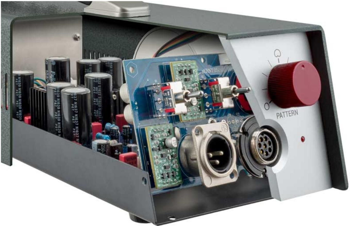
Auch in der Floor Box befindet sich noch ein zweiter völlig überdimensionierter Transformator von Rupert Neve Designs am Ende des Signalweges, der das Signal symmetriert und natürlich auch klangformend wirkt. Die Transformatoren sind übrigens magnetisch mit Mu-Metall geschirmt. In der Schaltung ist auch ein Hochpassfilter integriert.
