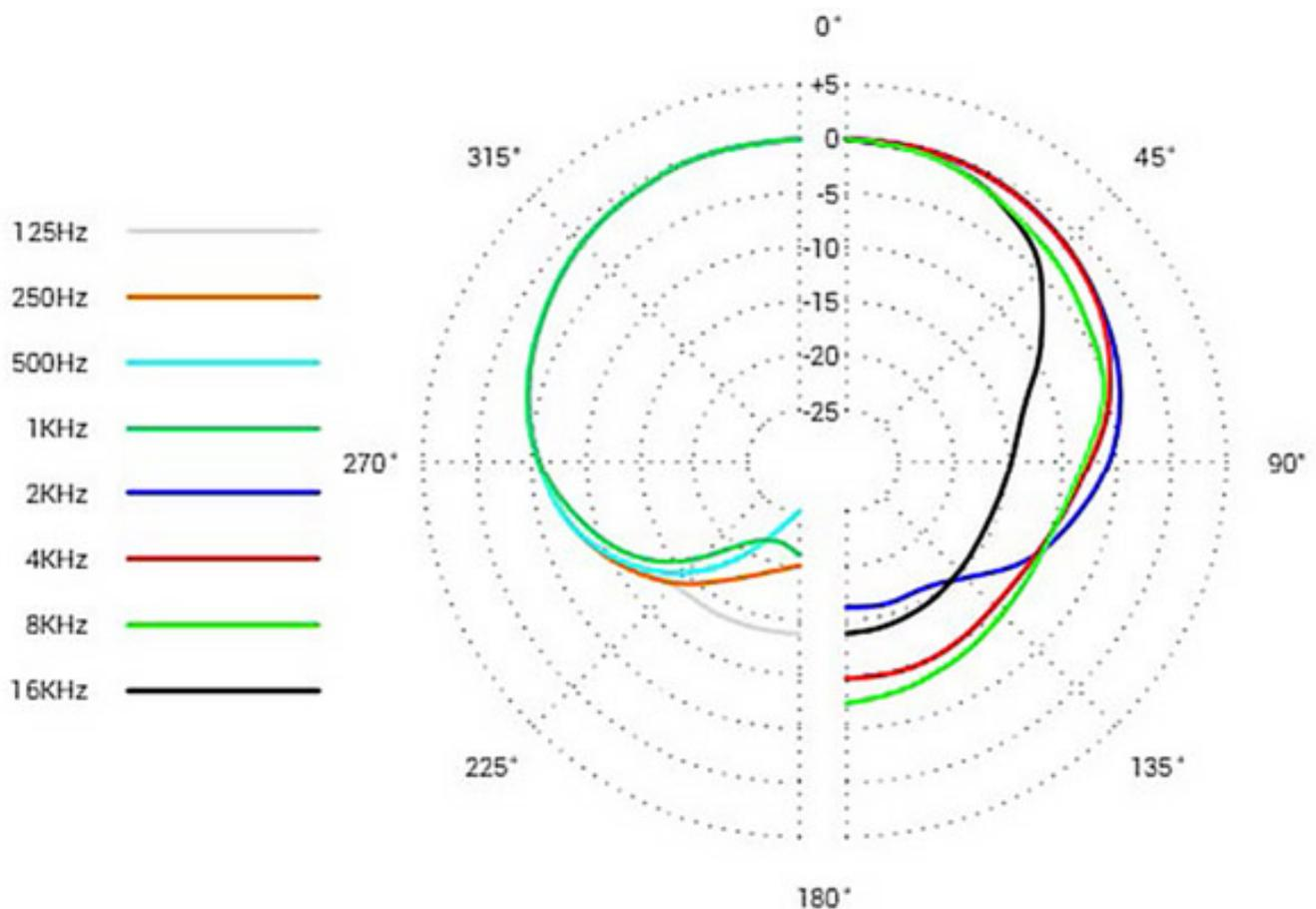
Im Polardiagramm erkennt man gut die Nierenrichtcharakteristik des Mikrofons (s. Abb. oben). Die Vor/Rück-Dämpfung ist sogar um einige dB größer als die beim X1 A.
