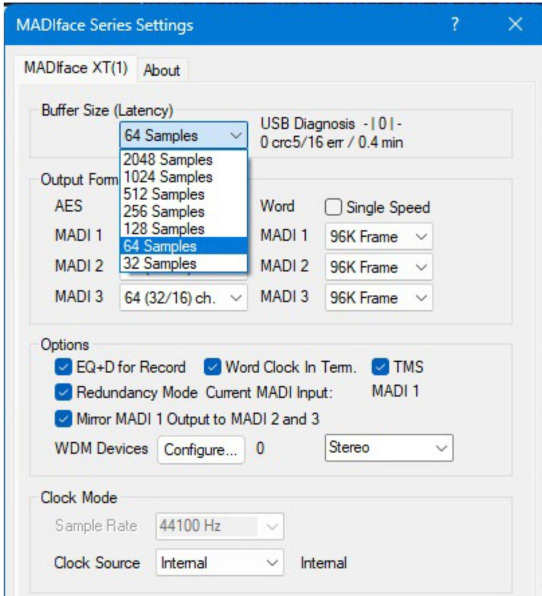
Das flexible Setting erlaubt die weitreichende Anpassung des eigenen Setups. Variable Puffergrößen von 32 bis 2048 Samples und Latenzen bei 44,1 kHz Abtastrate mit gerade mal 1,633 Millisekunde Ein- und 2,653 Millisekunden Ausgang unter Windows 11 konnten beeindruckend und unterstreichen den professionellen Standard, den RME konsequent verfolgt.
