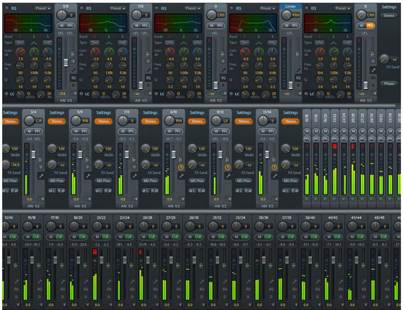
Ein Highlight zahlreicher RME-Audiointerfaces ist der integrierte DSP zur Echtzeitsteuerung anliegender Audiosignale in Form von flexiblen Routings für Recording, Mixes und Monitoring. Darüber hinaus stehen pro Kanal auch Effekte wie EQ, Dynamics, Reverb und Delay zur Verfügung. Die hierfür exklusiv zugeschnittene Software TotalMix ist kostenlos sowohl für Windows- als auch für Apple-Betriebssysteme auf der Downloadseite des Herstellers herunterladbar.
