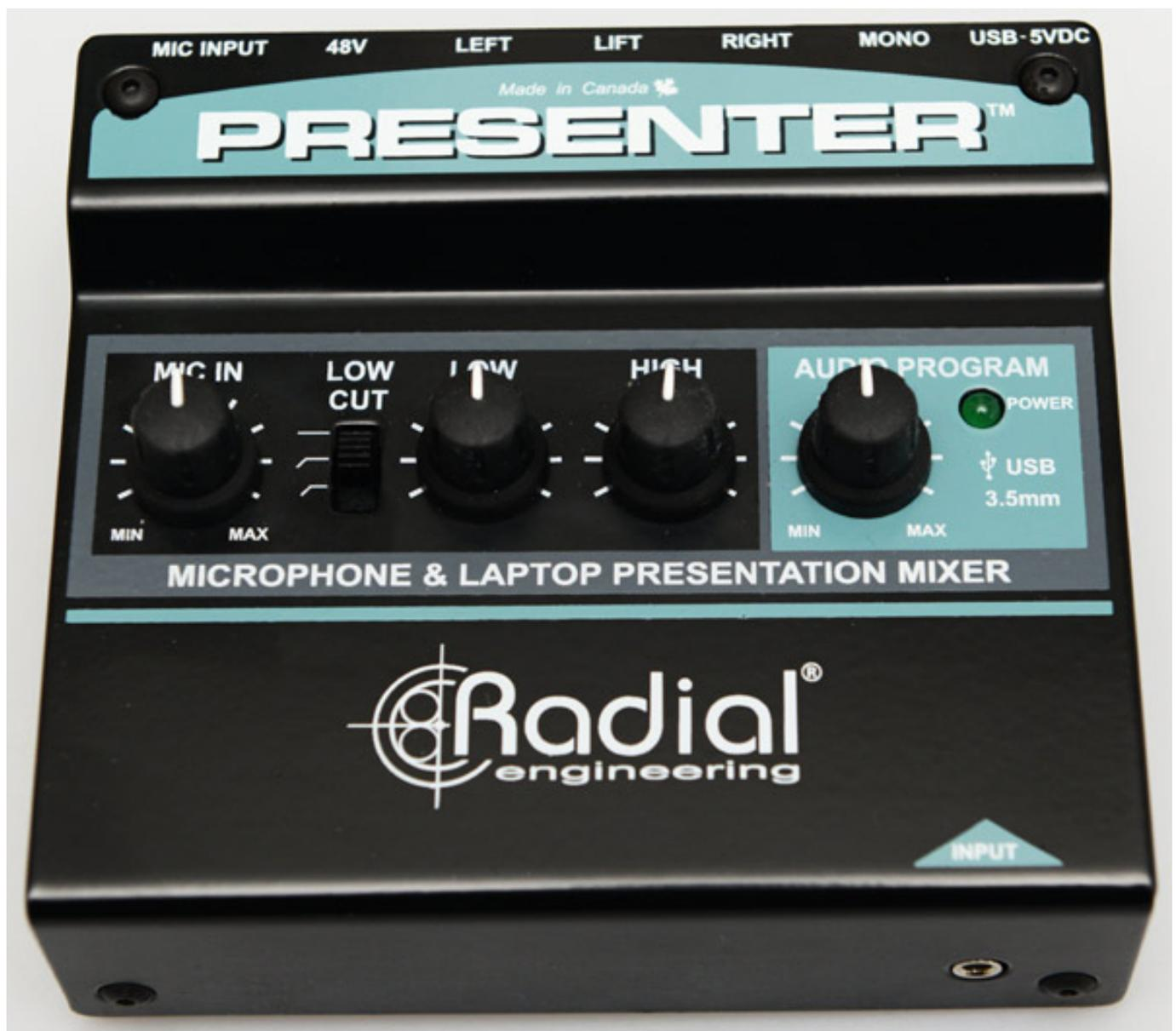
Auf der Oberseite befinden sich drei leicht identifizierbare Regler für Mikrofon-Eingangsempfindlichkeit, Tief- und Hochtonanpassung mit Hilfe zweier Kuhschwanzfilter sowie einen zweistufigen Tiefbassfilter mit 80 oder 120 Hz für eine einfache Klanganpassung. Rechts daneben ist ein Regler für den Audiopegel via USB und anliegende Audiosignale am 3,5-mm-Klinkeneingang angebracht.
