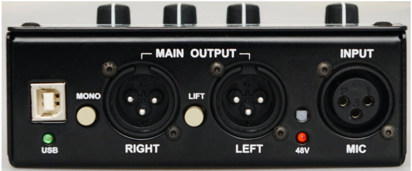
Auf der Rückseite befindet sich linksseitig ein Typ B USB-Eingang, gefolgt von zwei symmetrischen XLR-Ausgängen für eine PA-Anlage, die mittels Mono-Schalter auch ein summiertes Monosignal ausgeben. Das Audiokabel darf bis zu 100 Meter lang sein, ohne dass das übertragende Signal beeinträchtigt wird. Praktisch: etwaige Brummschleifen können mittels eines mittig positionierten Ground-Lift-Schalters unterbunden werden. Rechts außen befindet sich der Mikrofoneingang in Form eines XLR-Anschlusses.
