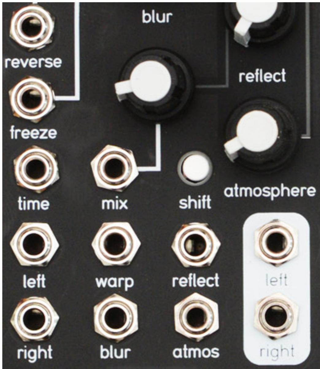
Nun zu den 3,5-mm-Miniklinke Ein- und Ausgängen. "freeze" und "reverse" lassen sich auch über ein Steuer-, bzw. Gate-Signal extern kontrollieren (Schwellwert 0,4 Volt). Erwähnenswert ist, dass die Reverse-Funktion auch nach einen Aus- und Wiedereinschalten erhalten bleibt. Da hat jemand mitgedacht. Neben den beiden Ein- und den Audio-Ausgängen (Werkseinstellung 10 V Spitze-Spitze) gibt es noch CV-Eingänge zur Spannungssteuerung von alle sechs Parameter.
