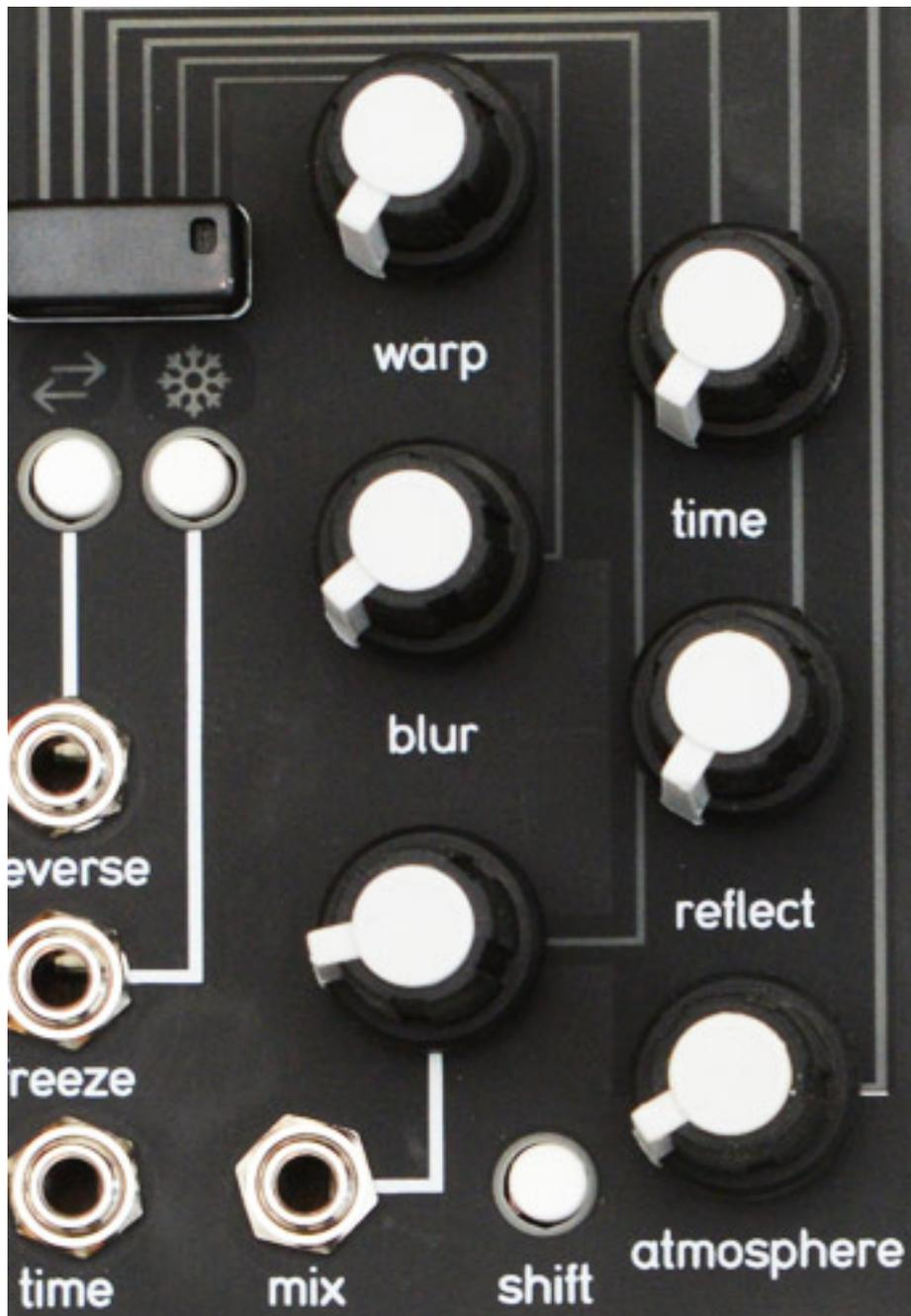
Mit dem Regler "mix" stellt man das Pegelverhältnis zwischen Originalsignal und Effekt ein. Wenn man das mit einem klassischen Hall vergleicht, dann könnte man "time" als Nachhallzeit bezeichnen, aber faktisch wird der Amplitudenanteil des Eingangssignals eingestellt. Mit dem Parameter "blur" wird dagegen die Frequenzkomponente des Eingangssignals justiert. Default-Stellung ist hier 12 Uhr.
