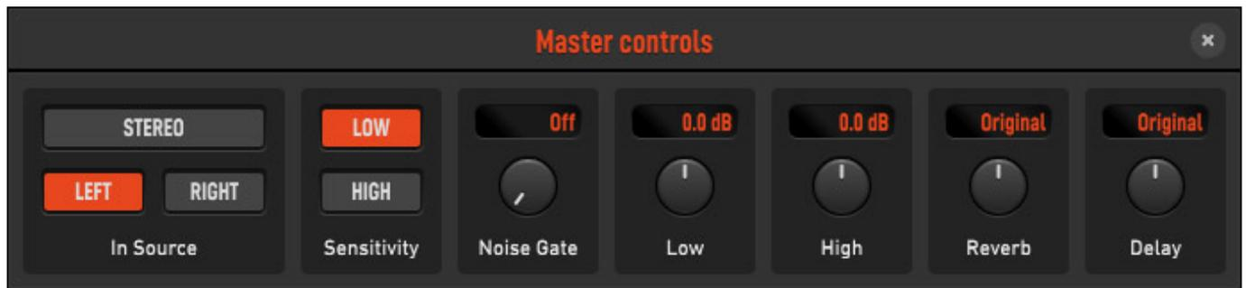
In dem Dialog "Master controls" lassen sich einige Audioeinstellungen vornehmen, wie die Signalquellenwahl (L/R) bei Stereokanälen, die Eingangsempfindlichkeit in zwei Stufen, ein Noise-Gate, Low/High-Filter, sowie Anpassungen des Delay und Hallanteils (Original = keine Veränderung).
