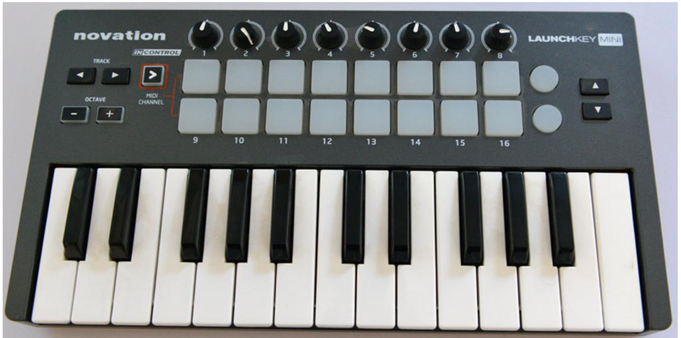
Zunächst zum kompaktesten Vertreter dem Launchkey Mini. Es bietet acht Endlosdrehgeber, 16 hintergrundbeleuchtete (rot, grün, gelb LEDs) Pads, z. B. zum Triggern von Drums oder Percussion, sowie zwei ebenfalls hintergrundbeleuchtete Multifunktions-Pads, die sich frei belegen lassen. Weiter gibt es je zwei Taster für Oktave-Transponierung und DAW-Track-Anwahl sowie eine sogenannten InControl-Taste.
