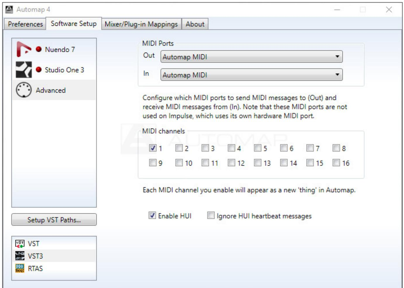
Nach der Installation ruf man über die Taskleiste Automap auf (s. Abb. oben). Dort lassen sich die Einstellungen für die kompatiblen und erkannten Applikationen durchführen. Die erkannten Plug-Ins lassen sich für die verschiedenen Plug-In-Formate in einer Liste aufrufen und entsprechend aktivieren (s. Abb. unten). Natürlich muss auch das Keyboard für die weiteren Schritte angeschlossen sein und es muss sich im Automap-Modus befinden.
