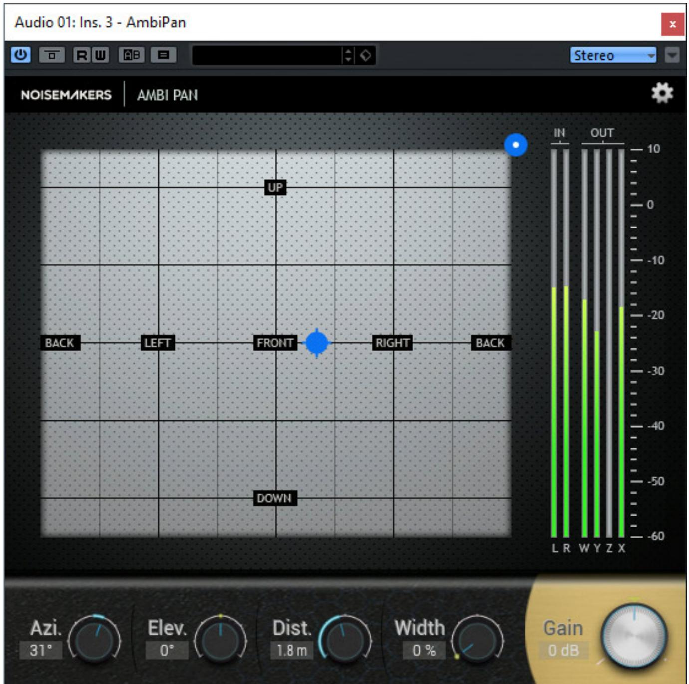
Die drei Werte Azimut (Richtung), Elevation (Erhebungswinkel) und Distanz lassen sich in beiden Darstellungsmodi auch über die Regler unten im Plug-In einstellen.
