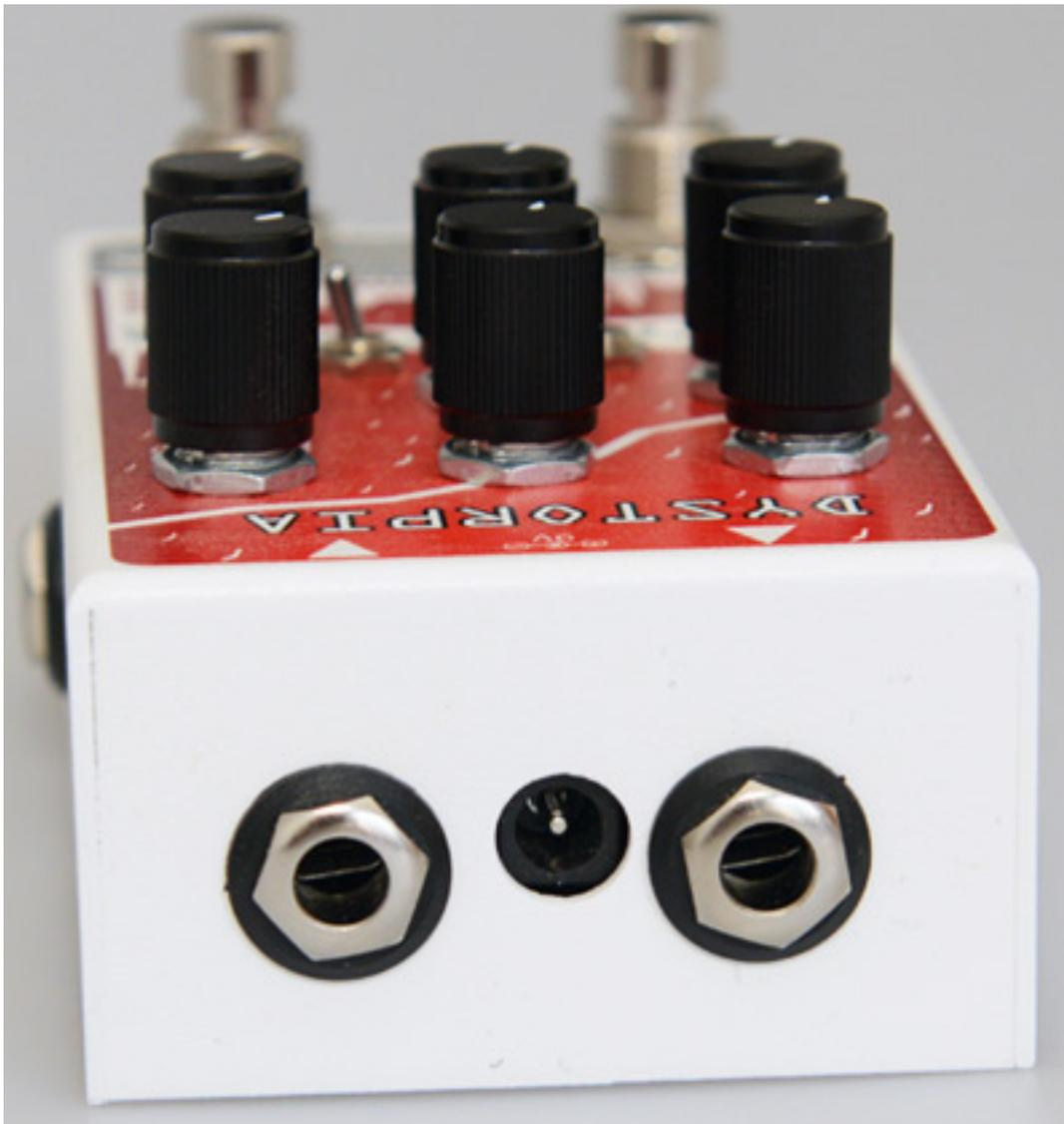
Rechts und links neben dem Stecker für die Spannungsversorgung befinden sich die 6,3-mm-Klinkenbuchsen Ein- und Ausgänge. Die Eingangsimpedanz beträgt 1 Megaohm und die Ausgangsimpedanz nominal 100 Ohm. Der nutzbare Eingangsspegel-Bereich liegt je nach Stellung des Reglers GAIN zwischen 0,5 und 9 Vpp.
