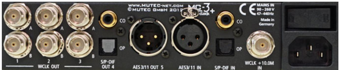
Nun aber zur Mutec MC-3+ Smart Clock, die als 1/2 19-Zoll-Gerät ausgeführt ist. Über Schrauben lassen sich auch Befestigungswinkel für den Rack-Einbau montieren.
