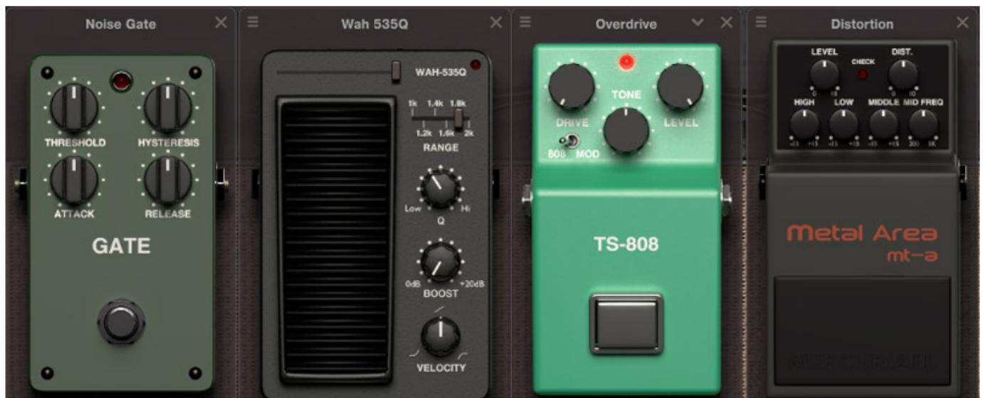
Das Noise Gate bietet neben der Einstellung des Gate-Schwellwertes die Einstellung der Attack- und Release-Zeit an sowie auch eine Hysterese für die Einstellung unterschiedlicher Ein- und Rücksetz-Schwellwerte. Das virtuelle Wah-Wah-Effekt-Pedal lässt sich in der Frequenz, der Filtergüte, dem Ausgangspegel und auch dem Ansprechverhalten einstellen.
