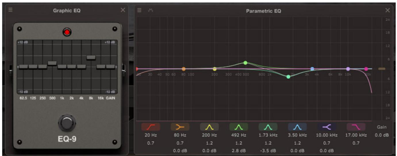
Neu hinzugekommen sind mit der Version 1.1, die im Juli 2020 veröffentlicht wurde, ein grafischer Equalizer (oben links) sowie ein parametrischer EQ (oben rechts) mit sechs parametrischen Filtern sowie einem Hoch- und Tiefpass.
