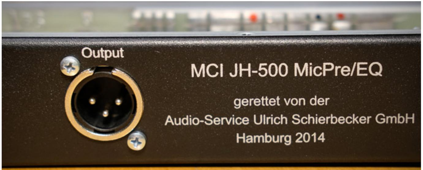
Unter der technischen Leitung von Mitarbeiter Toni Olmos entwickelte der Full-Service-Provider für professionelle Audiotechnik ein kompromissloses Konzept für Überarbeitung und Umbau der JH-500-Kanalzüge in einen speziell gefertigten Rack-fähigen 19-Zoll-Rahmen.
