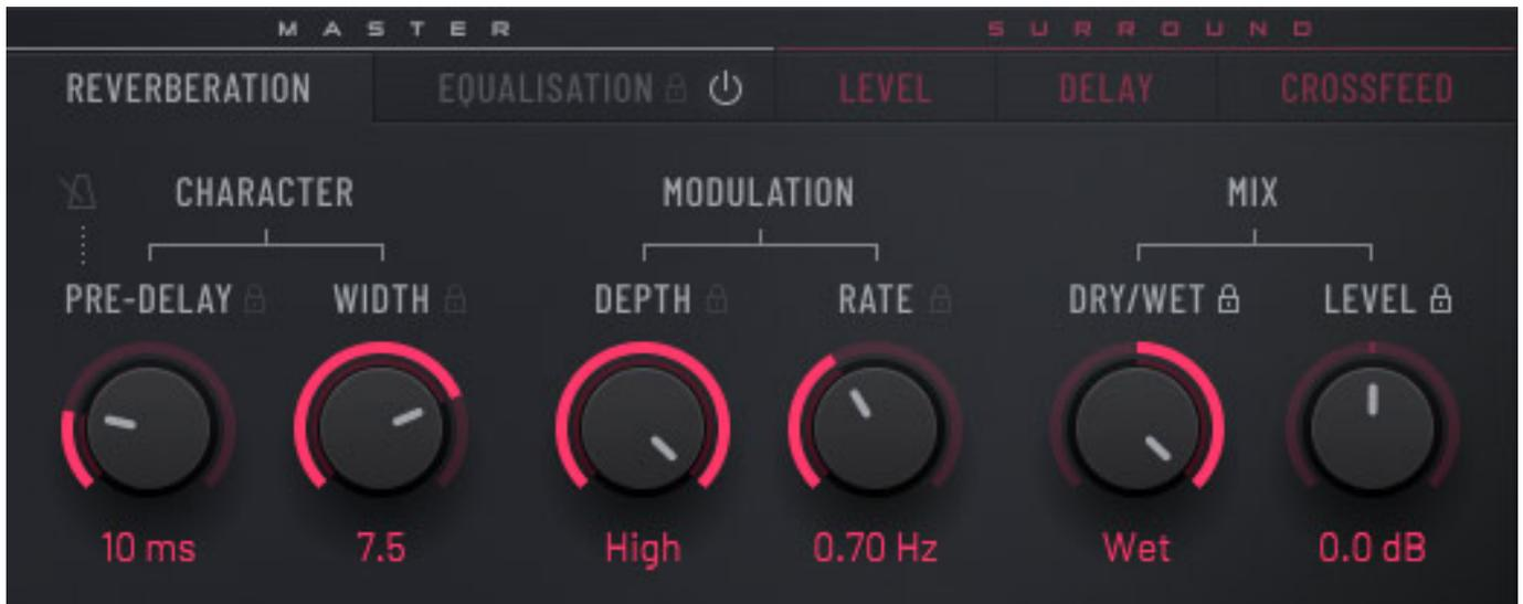
Der erste Reiter REVERBERATION (s. Abb. oben) bietet Zugang zu den Basis-Parametern des Reverbs an, wie PRE-DELAY und WIDTH (Stereo-Breite) oder den Ausgangspegel, bzw. Effektanteil. Auch eine Modulation lässt sich einstellen, was bei realen Hallplatten natürlich nicht gegeben ist. Also eine Option die erst durch die Simulation möglich geworden ist.
