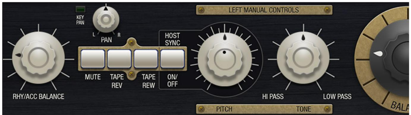
Für jede der beiden Manuals stehen Tonhöhen-Regler und ein Filterregler (je nach Reglerstellung Hochpass oder Tiefpass) bereit. In der Mitte befindet sich ein Balance-Regler wo sich das Pegelverhältnis der beiden Sektionen einstellen lässt und zudem lässt sich in der linken Sektion auch das Pegelverhältnis Rhythmus/Begleitungs-Subsektion noch justieren. Dazu noch verschiedene Tasten für die virtuelle Tape-Kontrolle, Mute-Taster für jede Funktion und ein Master-Pegelregler in der rechte Hälfte.
