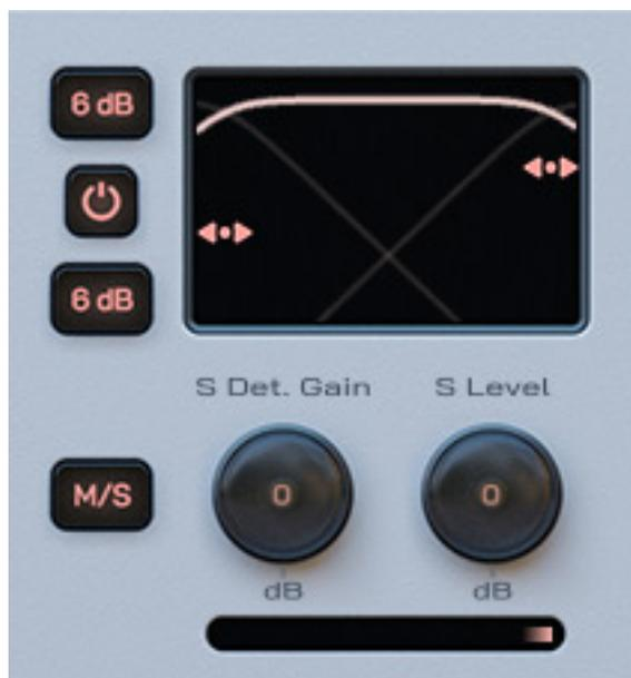
Darunter sind Regler verfügbar, die je nach Eingangskonfiguration verschiedene Parameter anbieten. So lässt sich der, bzw. die LFE-Pegel anpassen. gravitas kommt auch mit mehreren LFE-Kanälen klar. Bei Stereobetrieb erscheint hier statt dem LFE-Regler eine M/S-Sektion (s. Abb. oben). Die MS-Bearbeitung lässt sich auch deaktivieren und der Side-Detektor-Level und Side-Level kann verändert werden.
