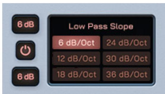
Mit der Maus lassen sich die Grenzfrequenzen der beiden Filter einstellen. Über Klicken auf einen der beiden Labels unter und über dem Ein/Ausschalter öffnet sich jeweils ein Dialog zum Auswählen der Filtersteilheit zwischen 6 bis 36 dB/Okt. in 6-dB-Schritten.
