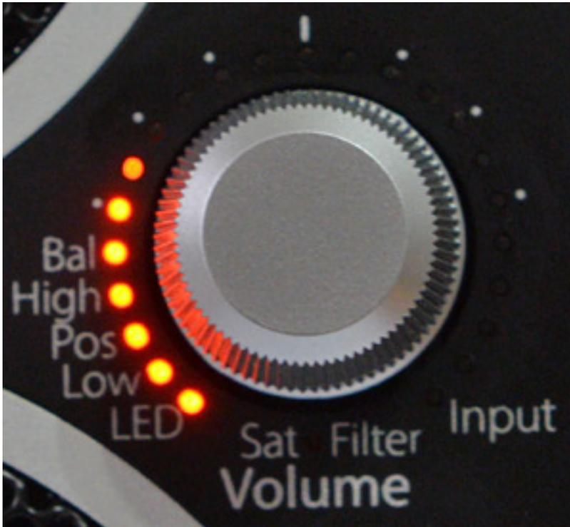
Durch Drücken gelangt man in den Editiermodus und kann so einen Menüpunkt anwählen und durch nochmaliges Drücken den angewählten Parameter dann verändern. Durch längeres Drücken verlässt man das Menü, bzw. passiert dies nach zehn Sekunden automatisch.
