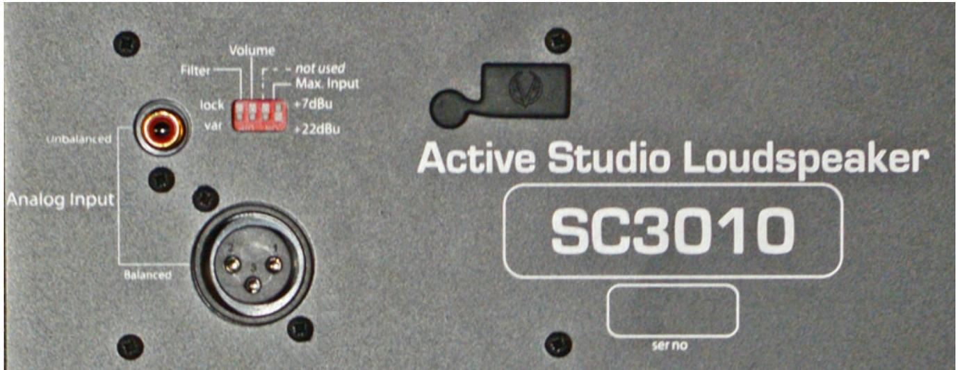
Auf der Lautsprecherrückseite befinden sich neben den Eingangsbuchsen noch drei kleine DIP-Schalter für die Wahl des Eingangspegels sowie für das Fixieren der aktuellen Einstellung der Filter und der Eingangsverstärkung.
