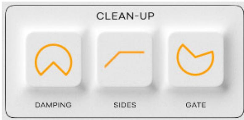
In der Sektion CLEAN-UP gibt es Filter und ein Gate. Mit DAMPING lassen sich hohe oder tiefe Frequenzen vom Hall-Signal entfernen. SIDES ist ein Parameter mit dem sich einstellen lässt ab welcher Frequenz ein Stereoeffekt wirksam werden soll. GATE stellt der Anwender den Einsatzschwellwert (links) und die Release-Zeit (rechts) des Gates im Hallweg ein.
