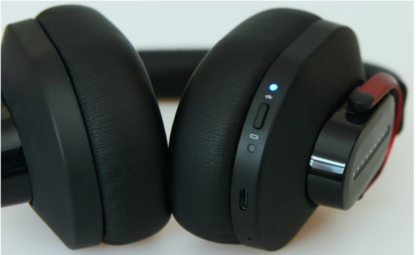
In der rechten Kopfhörerschale ist ein Mikrofon integriert. Mit dem Hi-X25 kann man also bei bestehender Bluetooth-Verbindung Anrufe vom Mobiltelefon annehmen, bzw. ablehnen (ein- oder zweifach Tippen auf den kapazitiven Bereich). Über ein längeres Auflegen der Hand, bzw. mit mehreren Fingern lässt sich auch ein ggf. vorhandener Sprachassistent im über Bluetooth verbundenen Endgerät starten. Das Mikrofon ist beim Kabel-gebundenen Betrieb nicht aktiv.
