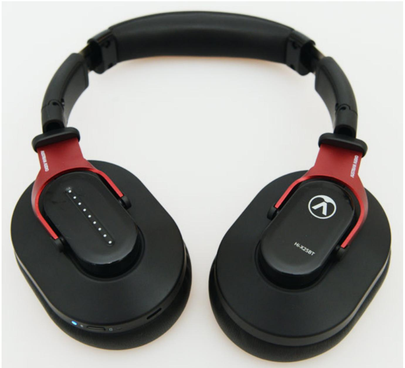
An der rechten Ohrschale befindet sich ein Streifen, mit dem eine Steuerung über Berührung (kapazitiv) möglich ist. Durch Streichen lässt sich die Lautstärke verändern und über ein-, zwei- oder dreifach Antippen gibt es eine Transportkontrolle (Play/Stopp, nächstes Stück, letztes Stück).
