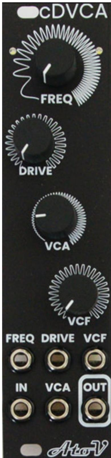
Die Bedienung erfolgt über vier Regler. Es lässt sich die Trägerfrequenz des Class-D Verstärker, die Verstärkung des VCAs sowie die Filterfrequenz einstellen. Die Regler dienen aber auch zugleich als Abschwächer für die vier CV-Eingänge FREQU, DRIVE, VCF und VCA und regeln daher die Eingangsabschwächung und Offset zu gleich. Weitere Buchsen sind natürlich noch der Audio-Ein- und Ausgang. Das war es auch schon an Bedienelementen und Buchsen.
