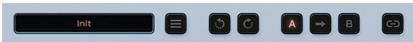
Ganz oben findet man die Handhabung der Plug-In-Presets, Undo/Redo-Funktion, zwei temporäre Speicher (A/B) zum Vergleich von Einstellungen und ein Button für den Aufruf eines sogenannten "Link Editors" auf den wir noch später eingehen werden.
