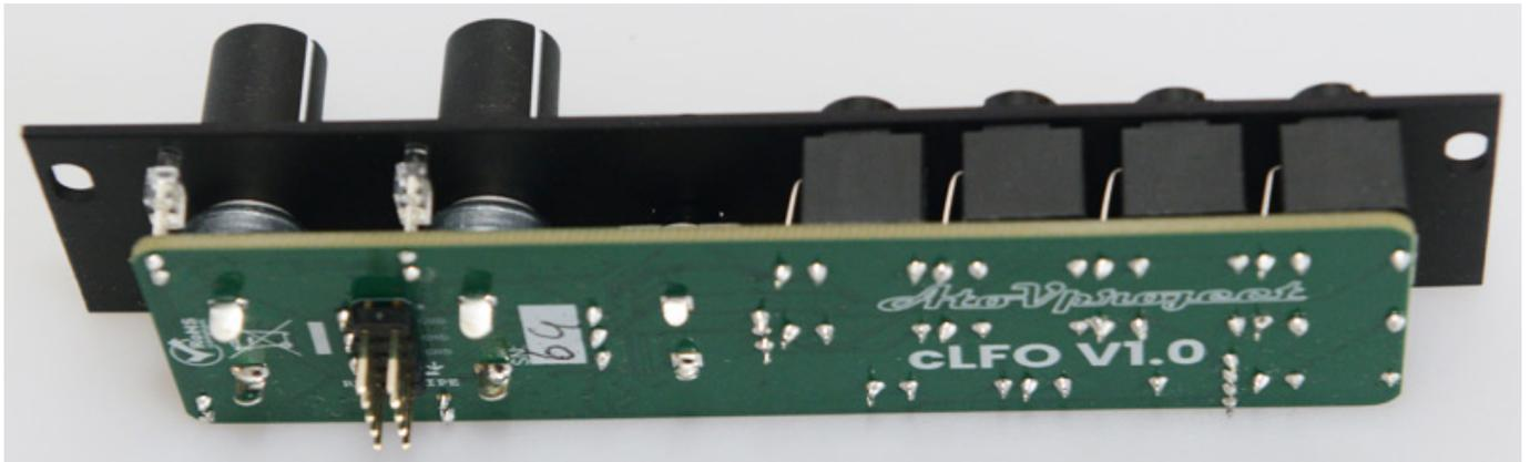
Der Betriebsstrom ist 6 HE breiten Moduls ist mit 49 mA Peak (+12 V), bzw. 57 mA Peak (-12 V) relativ gering. Die Frontplatte ist übrigens aus Aluminium. Das Modul wird sowohl mit einer schwarzen als auch mit einer silbernen Frontplatte angeboten.
