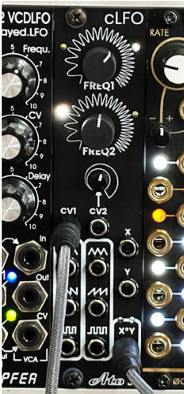
Zunächst zum LFO. Die getrennten Ausgänge ermöglichen ja auch ein Steuern der LFO-Frequenz über die eigene, natürlich frequenzidentische Ausgangswellenform. Damit lassen sich verschiedenste andere Wellenformen erzeugen zum Beispiel in dem man den Sägezahn-Ausgang von LFO2 mit dem CV2-Eingang verbindet. Mit dem Regler für den Modulationsgrad kann man dann fließend die Wellenform verändern. Auch ein verzögerter Einsatz des LFOs mit zunehmendem LFO-Pegel ist
