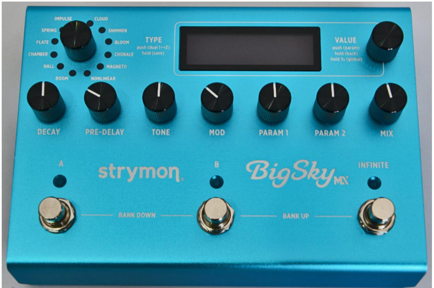
Geändert ist auch die Funktionalität der drei Fußtasten. Die ersten beiden links und in der Mitte sind für die direkte Anwahl eines von zwei Presets einer "Bank" und der ganz rechte ist nun für das Auslösen der INFINITE-Funktion da. Diese lässt sich über das Menü auf momentane Funktion (Momentary) oder Ein/Aus-Umschaltfunktion (Latching) wählen. Über das Drücken der Tasten links/Mitte oder Mitte/rechts kann der Anwender die aktuell aktive Bank verändern (zurück oder vor).
