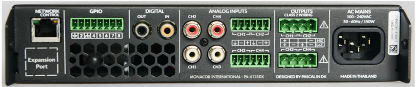
Der PA-4125DX verfügt ja über vier Verstärker. Er lässt sich in einem LoZ-Modus für den Anschluss von Lautsprechern mit vier oder acht Ohm Impedanz betreiben oder im HiZ-Modus für 70- oder 100-Volt-Betrieb, dann allerdings nur mit zwei statt vier Ausgangskanälen. Die Ausgangs-Nennleistung beträgt im LoZ-Modus je Verstärker 125 Watt und beim 70/100-Volt-Betrieb 250 Watt.
