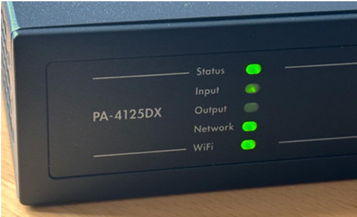
Die komplette Gerätebedienung erfolgt über den eingebauten HTML5-Web-Server. Dazu gibt es auf der Geräterückseite einen Ethernet-Anschluss für die Einbindung in ein lokales Netzwerk sowie ein 2,4-GHz-WLAN welcher als Access-Point oder als Client arbeitet. Ausgeliefert wird das Gerät im Access-Point-Modus und der Zugang für die Erstkonfiguration erfolgt dann mit einem Standard-Passwort.
