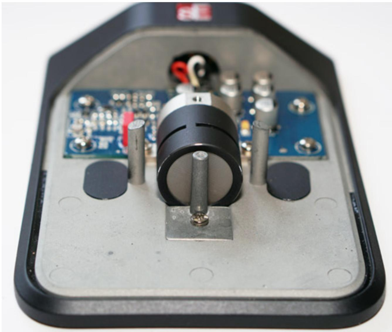
Die Unterseite ist gummiert um eine gute Rutschfestigkeit zu erzielen. Hier finden sich, etwas versenkt angebracht, die drei Schalter zur Klang- und Pegelbeeinflussung. Zwei Gummistücke sind perforiert und lassen sich entfernen, falls das Mikrofon festverschraubt angebracht werden soll.
