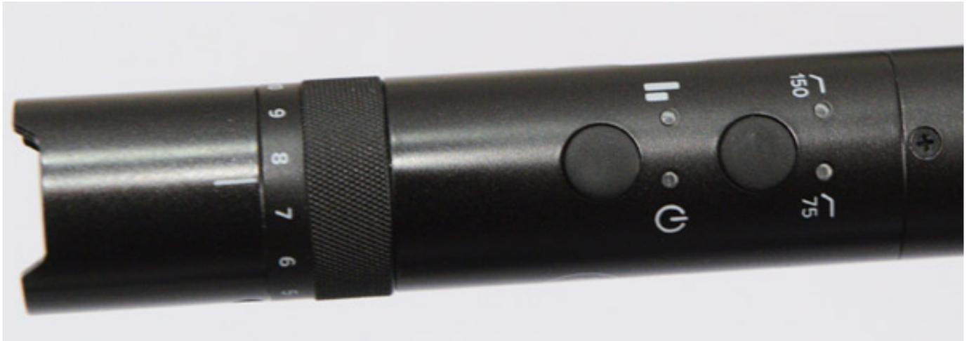
Das Mikrofon bietet zwei Tasten zur Bedienung. Mit der einen Taste lässt sich ein Hochpaßfilter mit einer Grenzfrequenz von 75 oder 150 Hz zuschalten und mit der Ein/Ausschalttaste lässt sich durch Antippen im eingeschalteten Zustand der linke Kanal um 10 dB absenken (Pad-Funktion).
