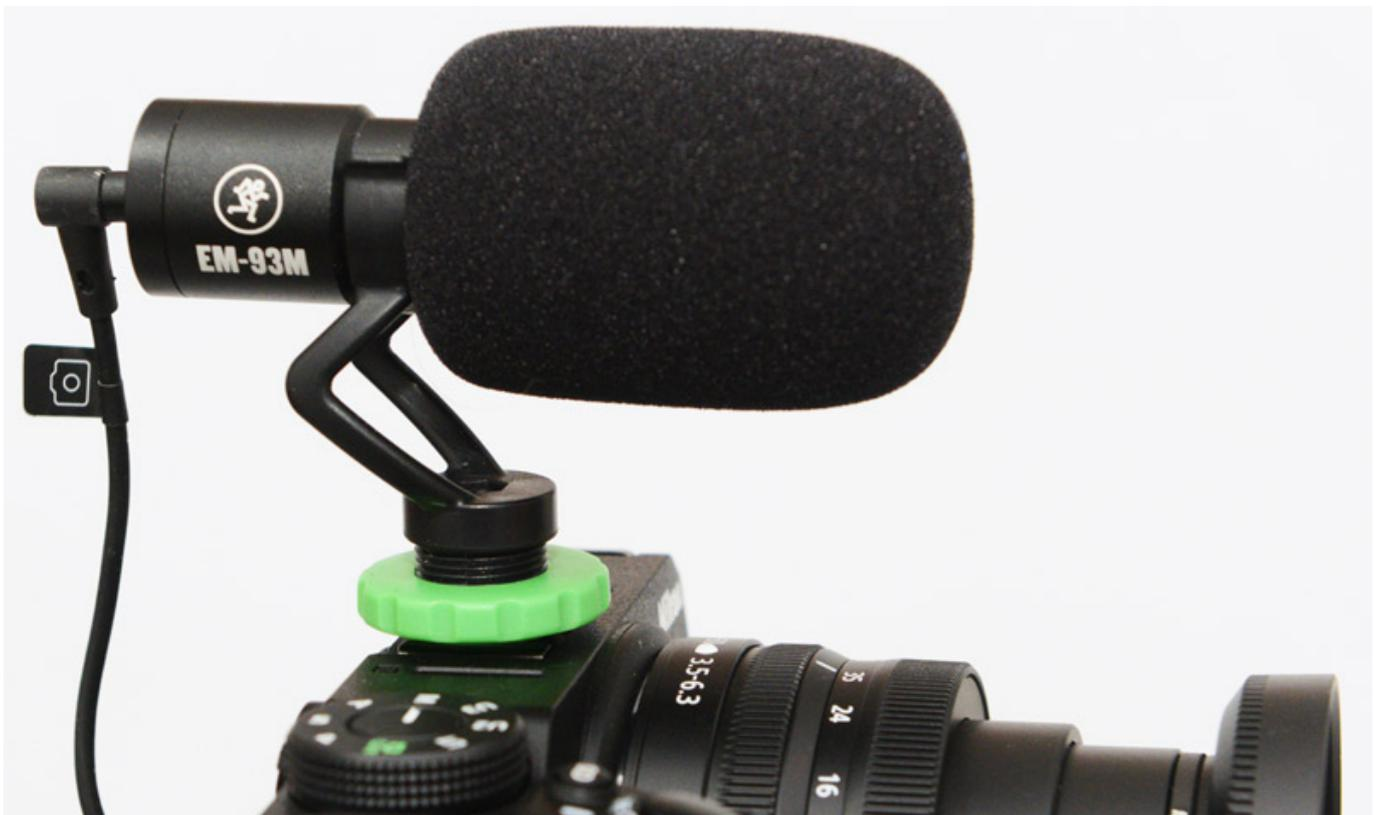
Die 3,5-mm-Klinkenbuchse für den Mikrofonausgang befindet sich hinten am Mikrofon. Der Übertragungsbereich wird vom Hersteller mit 35 Hz bis 20 kHz und die Empfindlichkeit mit -42 dB (bezogen auf V/Pa) angegeben - also ca. 8 mV/Pa. Der Geräuschspannungsabstand beträgt 68 dB und die Ausgangsimpedanz 680 Ohm.
