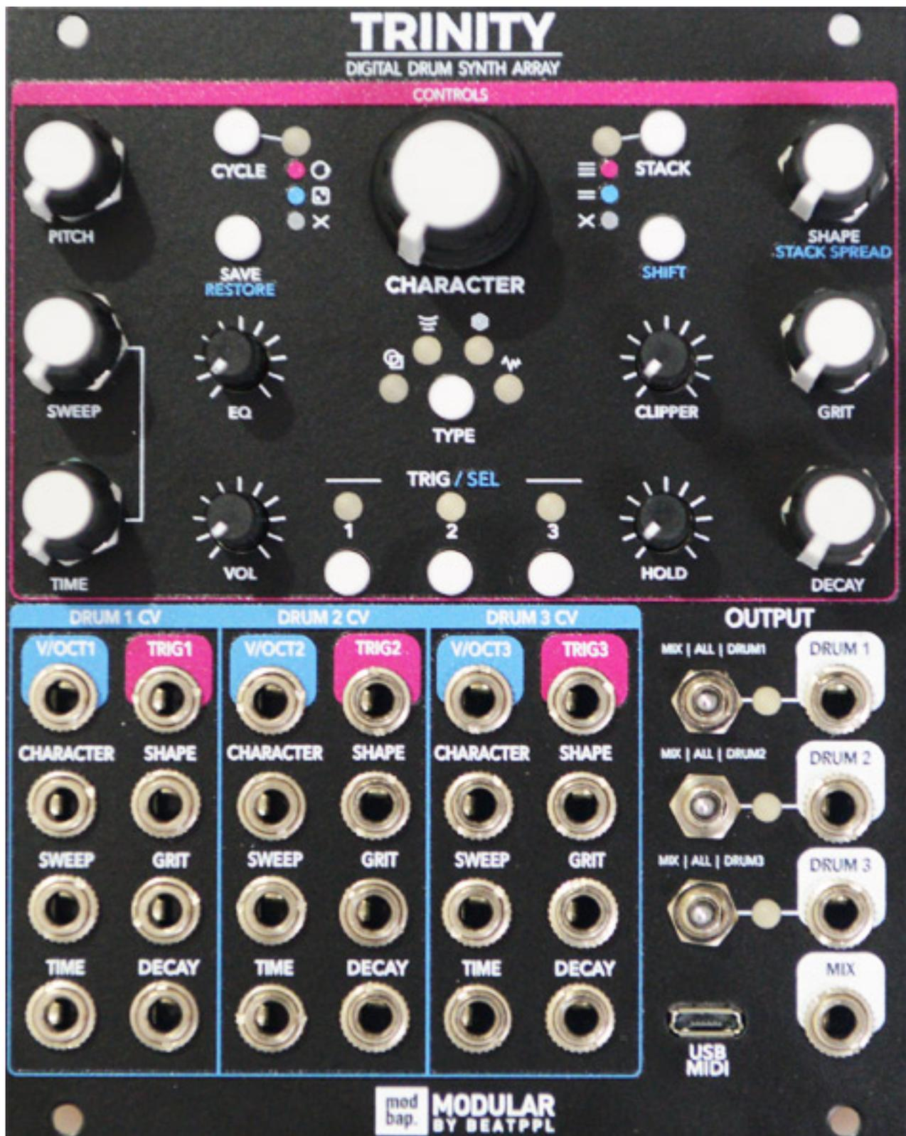
Das Modul ist was die Anordnung der Bedienelemente und Ein/Ausgangsbuchsen angeht sehr aufgeräumt, oben befinden sich Regler und Schalter und unten die 3,5-mm-Klinkenbuchsen, aufgeteilt in vier Gruppen mit Eingängen für die drei Stimmen und dann die Ausgangssektion mit einer Schaltmatrix.
