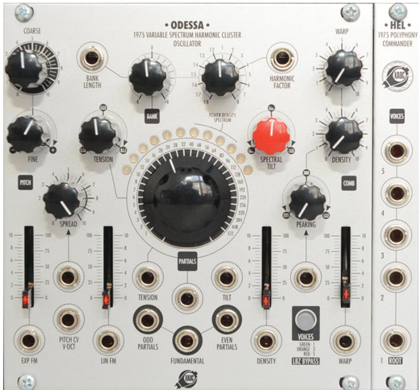
Die Anzahl der verfügbaren Eurorack-Oszillatoren ist riesig. Wenn man sich aber die einzelnen Synthesarten anschaut, dann ist die Additive Synthese nicht so sehr verbreitet und die verfügbaren Module unterscheiden sich stark in Ihren Möglichkeiten Einfluss auf die Synthese zu nehmen. Eines der interessantesten Oszillatoren mit Additiver Synthese ist der "Odessa" von Xaac Devices aus Polen, der sich mit der Erweiterung "Hel" auch mehrstimmig betreiben lässt.
