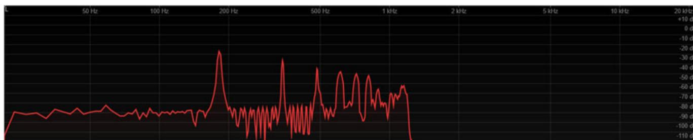
Bei Reglerstellung nach links werden die Frequenzabstände aber geringer als ein Vielfaches und dadurch wird das gesamte Spektrum mehr oder weniger gestaucht (s. Spektrum oben bei Linksanschlag).
