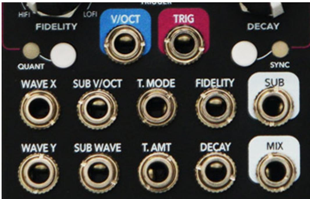
Über den Taster QUANT lässt sich eine Echtzeit-Tonhöhen-Quantisierung (Halbtöne) zuschalten und über SYNC kann der Anwender die Wave-Synchronisation zurücksetzen. Der Status beide Funktionen wird über je eine Indikator-LED angezeigt.
