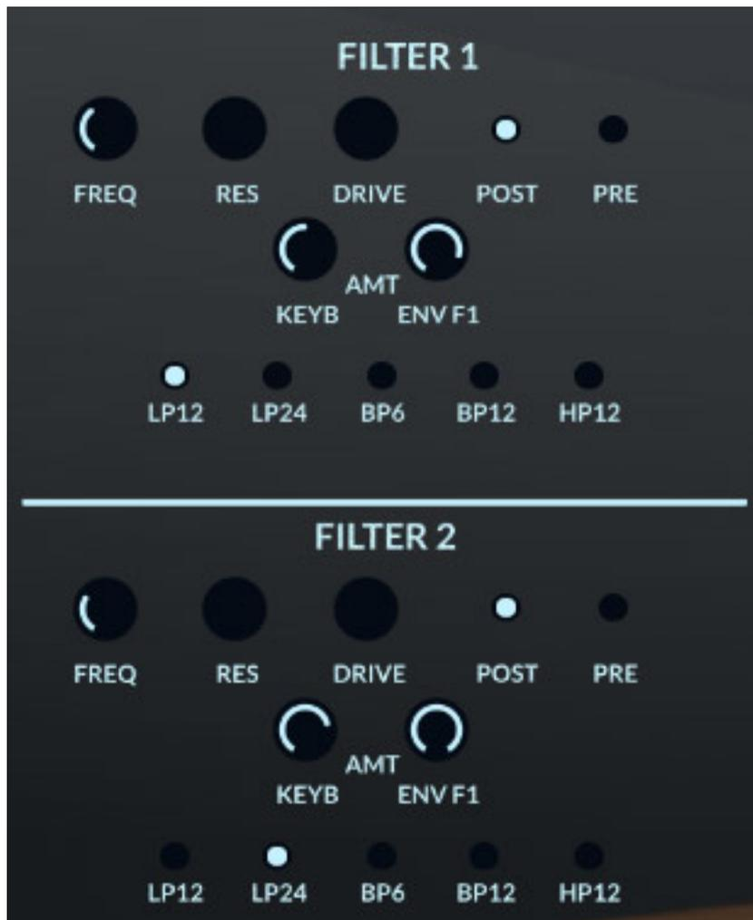
Bei den Filtern stehen Tiefpass mit 12 und 24 dB, Bandpass mit 6 und 12 dB sowie Hochpass mit 12 dB Steilheit zur Auswahl bereit.
