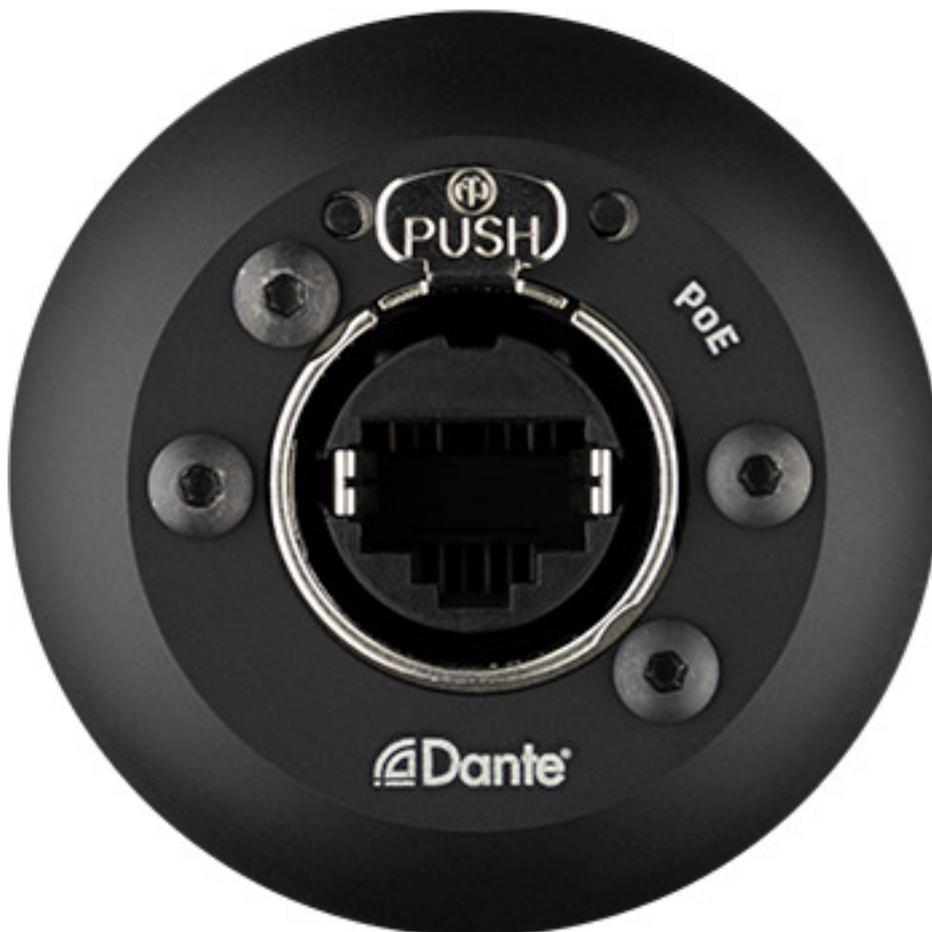
Voyage Audio bietet ab dem ersten Quartal 2023 mit dem "Spatial Mic Dante" das Mikrofon auch mit einer DANTE Digital-Audio-Schnittstelle an (s. Abb. oben). Über die MicNet-Steuerungs-App lässt sich auch die Dante-Version fernsteuern. Die Daten-Version ist zudem Power-over-Ethernet-fähig (PoE) und lässt sich so über die Ethernet-Schnittstelle fernspeisen.
