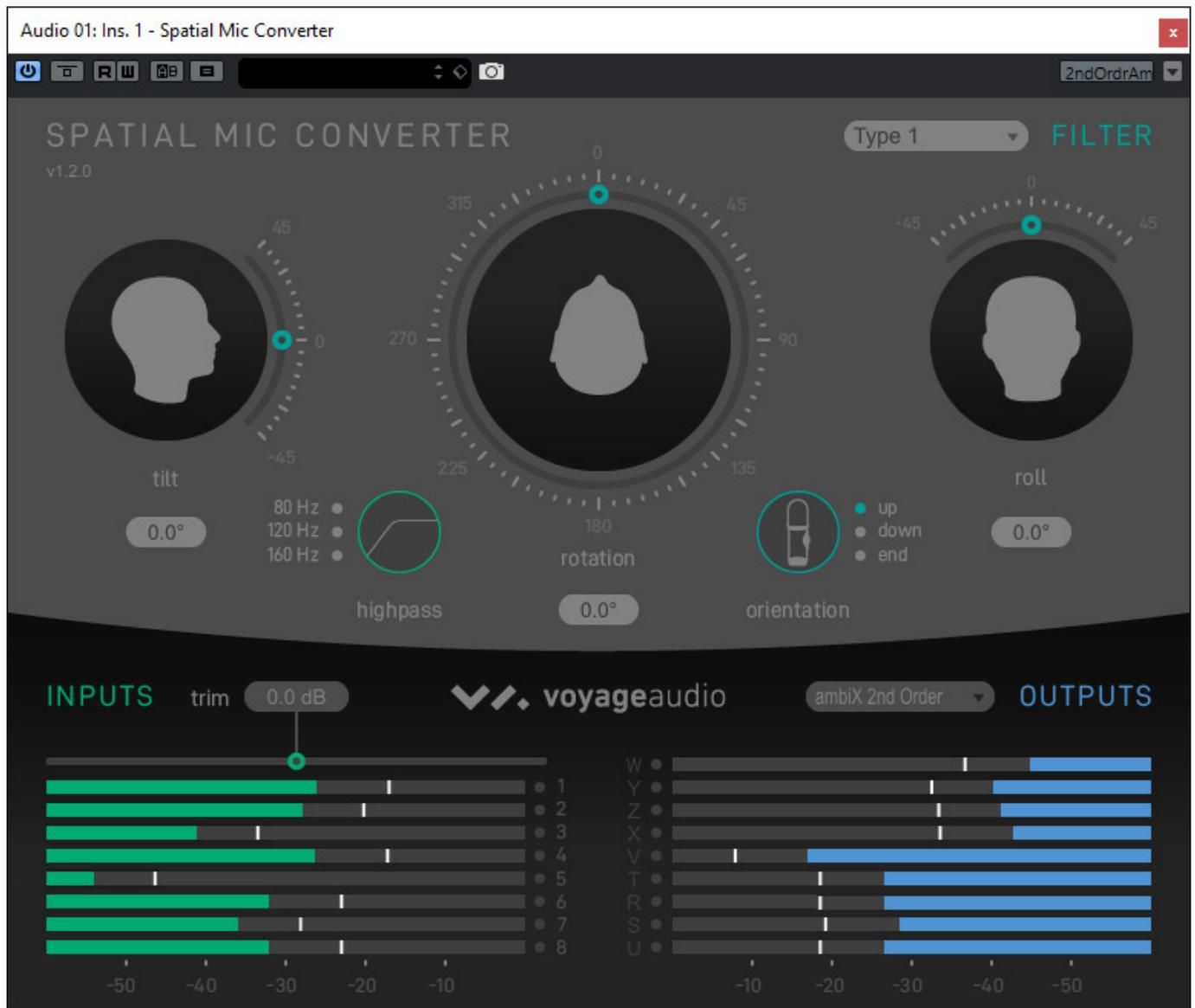
In dem Plug-In lässt sich unter anderem die Mikrofonorientierung einstellen. Normalerweise zeigt der Bedienknopf am Mikrofon nach vorne und der Mikrofonkorb nach oben. Über den virtuellen Taster "orientation" lässt sich dies aber auch ändern - natürlich auch nach der Aufnahme. So ist umgekehrter Betrieb - also Mikrofonkorb nach unten - sowie auch liegender Betrieb möglich.
