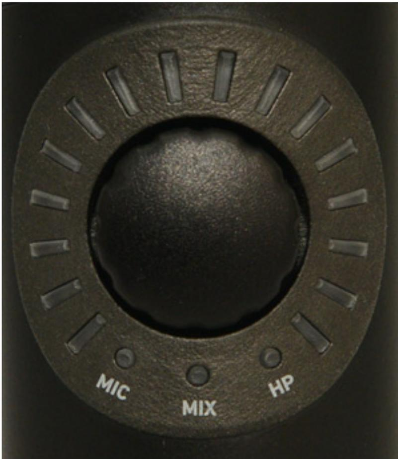
Auf der Vorderseite des Mikrofons ist ein Druck-/Drehgeber mit einem LED-Kranz sowie drei Status-LEDs verfügbar. Durch mehrmaliges Drücken lässt sich der Bedienmodus von Mikrofon-Eingangspegel (MIC) auf Kopfhörerpegel (HP) oder auch Mischverhältnis Mikrofon/USB-Audio-Rückweg (MIX) umstellen. Mit dem Drehgeber wird der Wert eingestellt und mit dem LED-Kranz angezeigt. Die vierte Betriebsart ist der normale Betriebsmodus, bei dem der LED-Kranz dann als Pegelanzeige genutzt wird.
