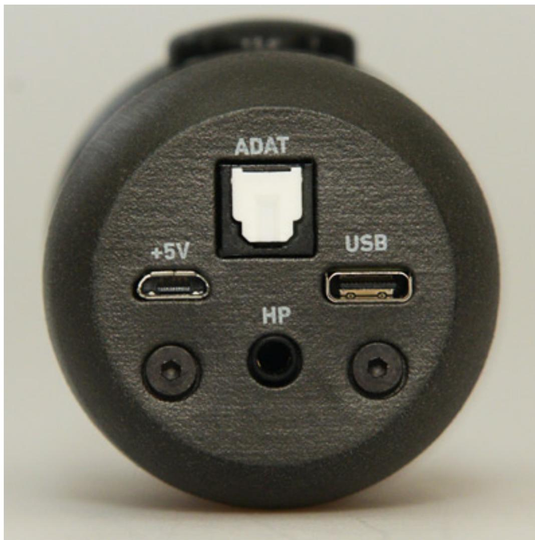
Hier ist unter anderem ein Micro-USB-Anschluß vorhanden, der ausschließlich der Spannungsversorgung dient. Damit lässt sich das Mikrofon auch mit USB-Powerbanks im Außeneinsatz betreiben. Des Weiteren gibt es ein USB-C-Anschluss (USB 2.0) für die Bidirectionale-Audioverbindung, das bedeutet Audio wird an den angeschlossenen PC/Mac ausgegeben (8-Kanal A-Format mit 24 Bit und maximal 96 kHz Abtastrate) aber auch vom PC/Mac an das Mikrofon.
