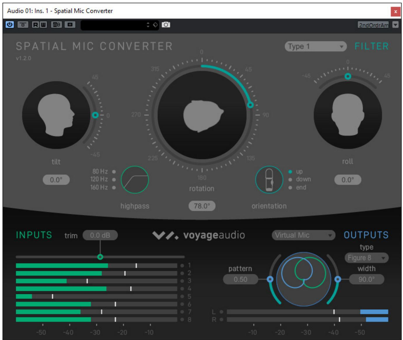
Darüber hinaus lässt sich auch eine Betriebsart "Virtual Mic" anwählen (s. Abb. oben), bei dem aus dem Mikrofon-Array ein virtuelles Mikrofon mit gewählter Richtcharakteristik gerechnet wird.
