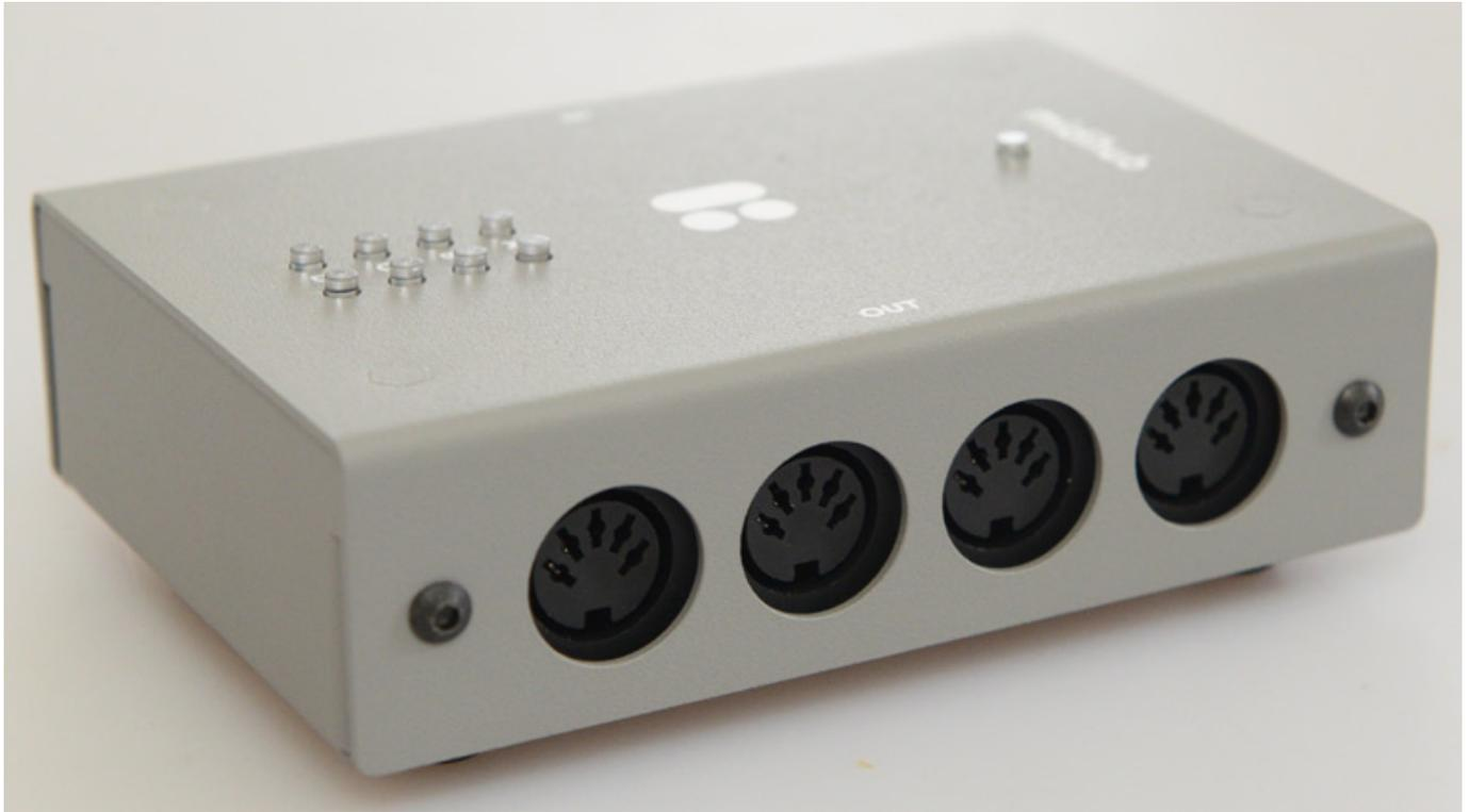
Der Midihub verfügt neben einem USB-B-Port für den DAW-Anschluss über vier MIDI-Ein- und vier MIDI-Ausgänge in Form von 5-poligen DIN-Buchsen, jeweils vier auf einer Seite des Gerätes.
