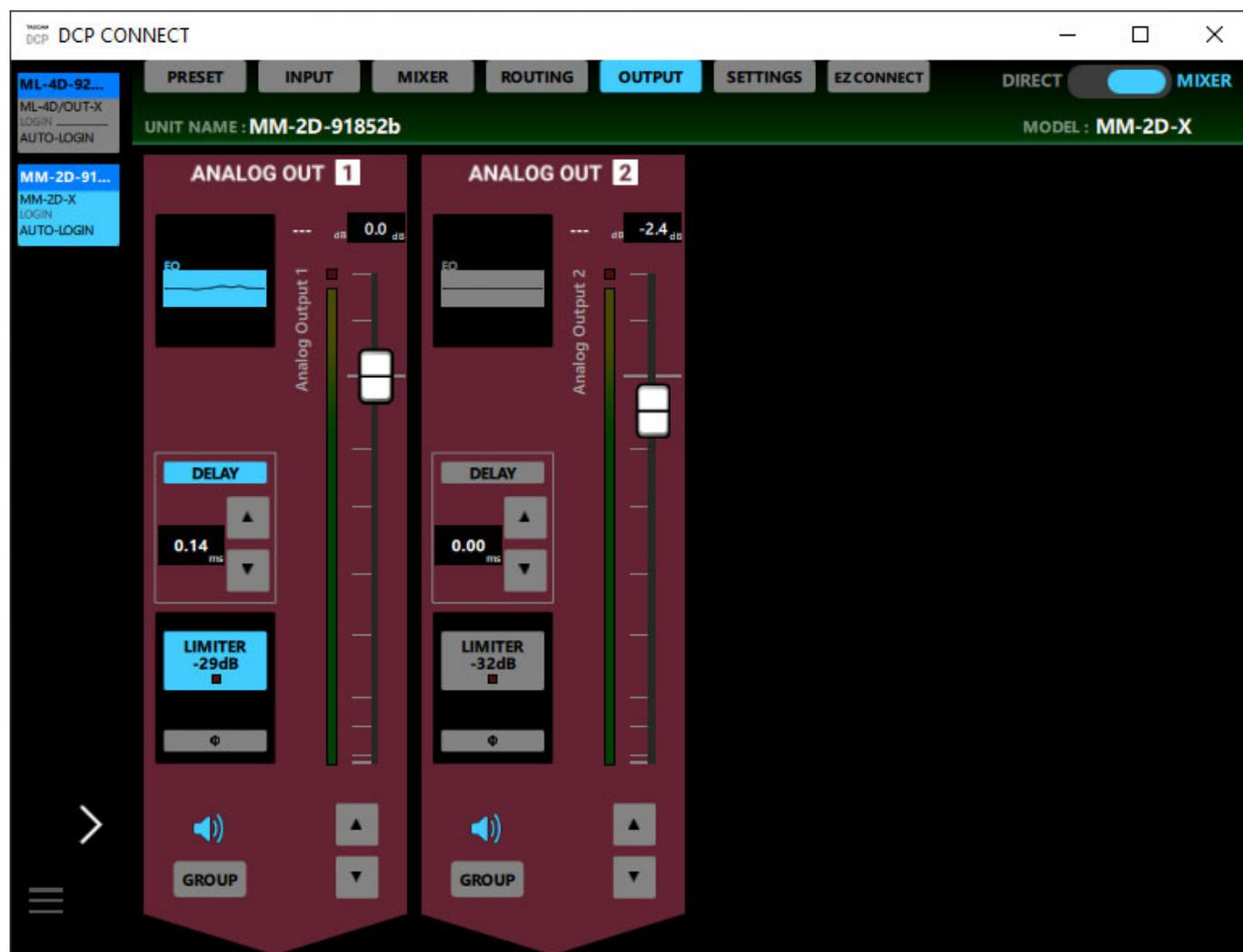
Der Ausgangs-Equalizer (s. Abb. unten) ist sogar noch etwas umfangreicher. Er bietet acht vollparametrische Bänder sowie High/Low-Shelving/Cut. Auch hier lässt sich die Phase umkehren und der Schwellwert des Limiters im Bereich von 0 bis -54 dB einstellen.
