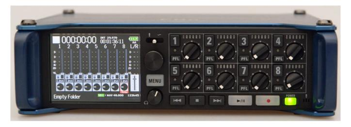
Weiterer Vorteil, ist, dass beim F8n sich die Remote FRC-8 nun vom F8n aus speisen lässt und man benötigt dafür also keine extra Spannungsversorgung oder eingelegte Batterien im FRC-8.
