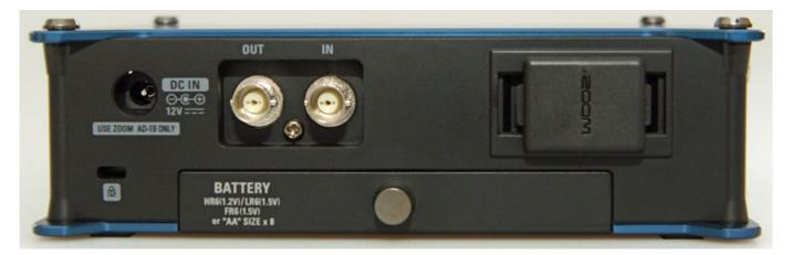
Die Rückseite ist nun wegen der Änderung des Batteriefachs natürlich überarbeitet worden. Man sieht auch die andere, günstigere Ausrichtung des Steckers für die Zoom-Aufsteckmikrofone, die nun um 90 Grad gedreht ausgeführt ist. Daher muss man den Recorder beim Betrieb mit einem Zoom-Stereomikrofon nun nicht mehr
