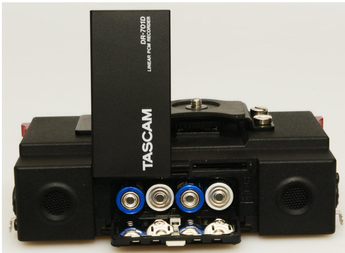
Mittig befindet sich hinter einer Plastikabdeckung neben dem SD-Kartenschacht das Batteriefach, in dem sich vier AA-Batterien ohne aufwendigen Abbau des Setups während des Drehs austauschen lassen. Je nach Aufnahmedauer und Abtastrate lassen sich SD-Karten mit maximal 2 Gigabyte, SDHC-Karten mit bis zu 32 Gigabyte sowie SDXC-Karten mit maximal 128 Gigabyte nutzen.
