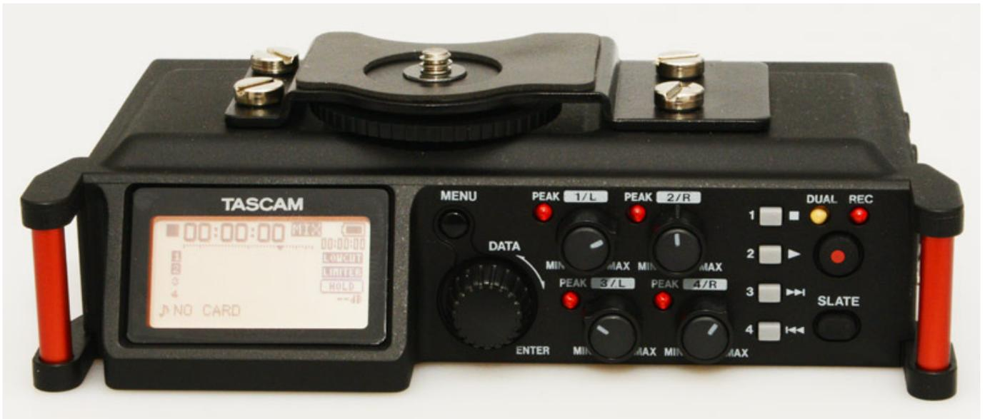
Die Dimensionen des DR-70D (Foto oben) liegen bei 169 mm Breite, 107 mm Tiefe und 55 mm Höhe bei einem Gewicht von 530 g ohne Batterien.
