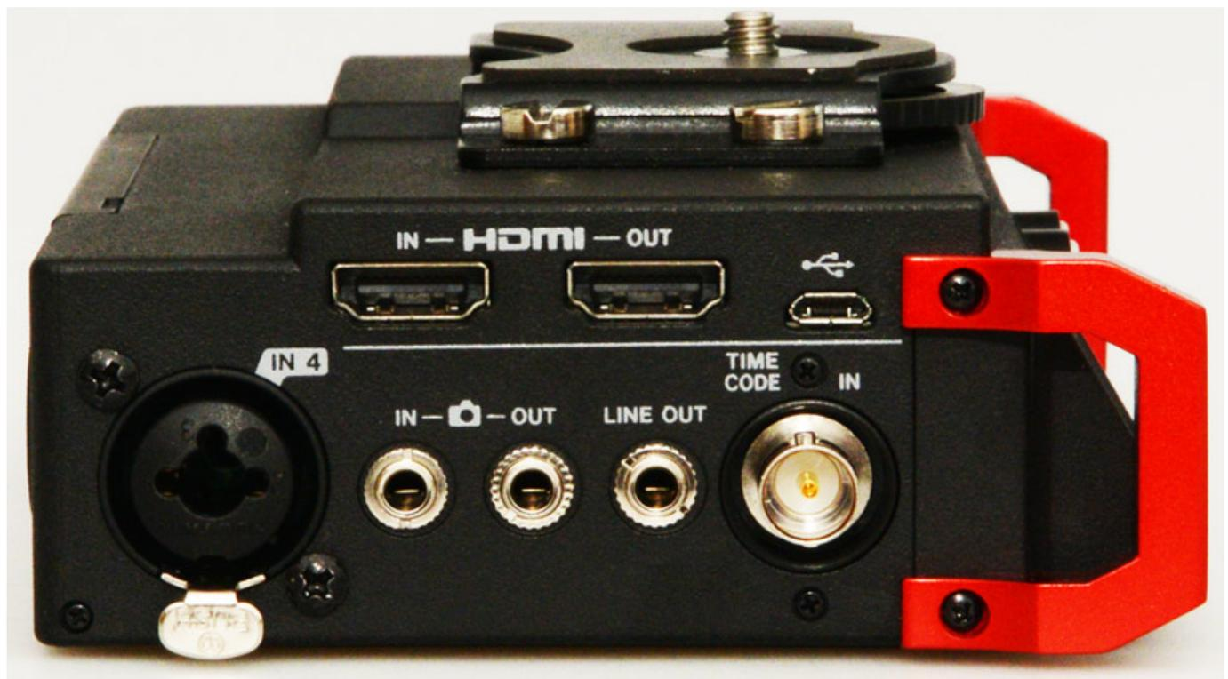
Der DR-701D verfügt im Gegensatz zum DR-70D auf der linken Gehäusesseite neben Word-Clock-Eingang (BNC) für Timercode -Quelle auch über HDMI-Anschlüsse. Damit lassen sich Aufnahmen mittels HDMI-Ein- und Ausgang automatisch gleichzeitig mit der Videoaufnahme einer angeschlossenen DSLR-Kamera starten und stoppen, was die Nachbearbeitung sehr erleichtert. Voraussetzung ist hierbei,
