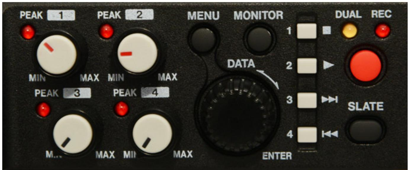
Rechtsseitig dominiert das Datenrad, mit dem man durch Druck auf das Rad Menüpunkte aktivieren, sowie durch Drehen Menüfunktionen auswählen und Werte verändern kann. Direkt daneben sitzen kleine Transporttasten, mit denen mittels Stopp, Wiedergabe, Startpunkt, Endpunkt in aufgenommenen Audiodateien navigiert wird. Die rechts oben platzierte Record-LED sowie die Dual-Record-LED sind oberhalb des Aufnahmebutton platziert und während des Betriebs auch bei schlechter Beleuchtung gut sichtbar.
