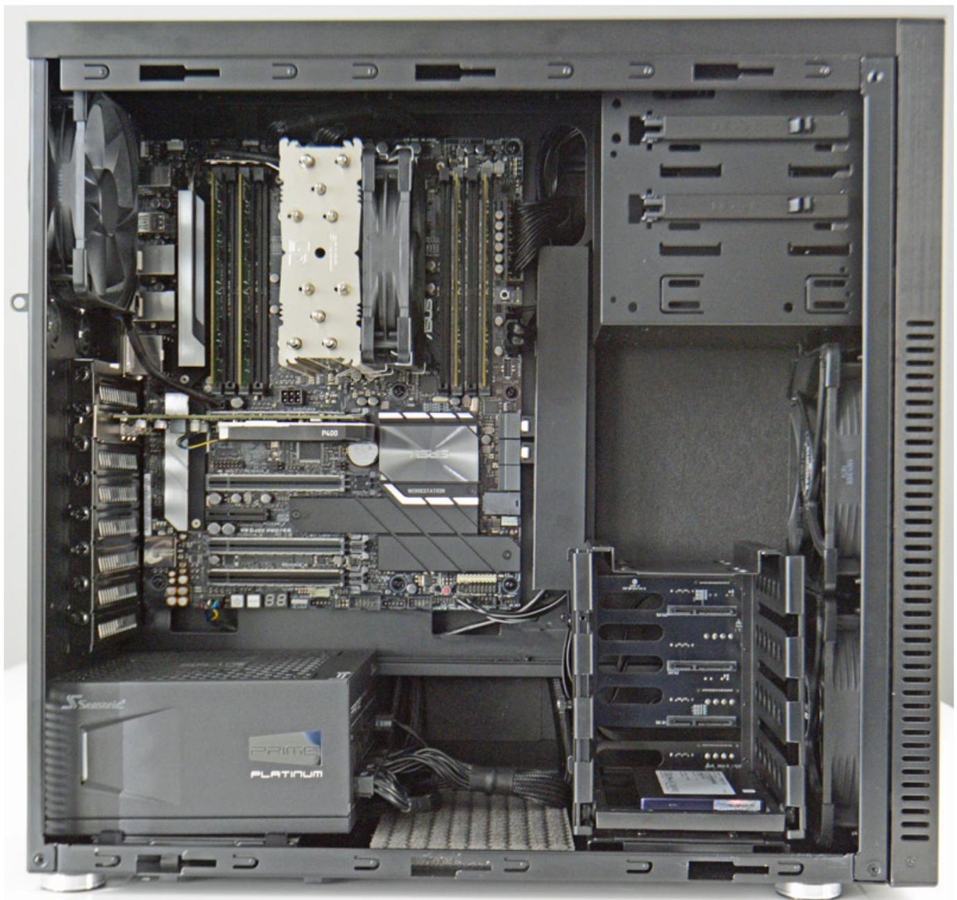
Das von XI-MACHINES entwickelte Gehäuse bietet Platz für Datenspeicher-Erweiterungen: Der Austausch oder die Erweiterung von Festplatten oder SSDs für umfangreiche Sample Libraries und datenintensive Multitrack-Aufnahmen mit 96 kHz oder mehr lässt sich dank einer internen 3,5-Zoll-Backplane mit vier Einschüben werkzeuglos und ohne Kabel ziehen zu müssen schnell und problemlos, selbst von ungeübten Laien, bewerkstelligen.
