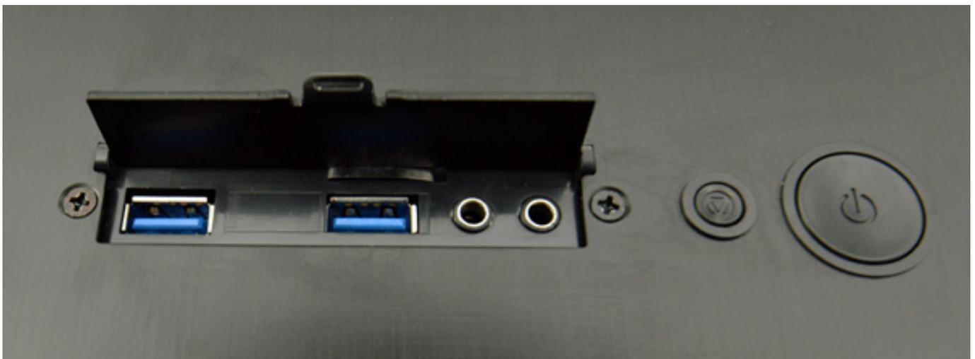
Der Ein- und Ausschalt- sowie der Resetknopf befindet sich auf der Oberseite des Towers. Ebenfalls auf der Oberseite unter einer Klappe verborgen befinden sich zwei USB 3.0 Anschlüsse und zwei 3,5-mm-Klinkenbuchsen für Onboard-Audio (s. Abb. oben).
