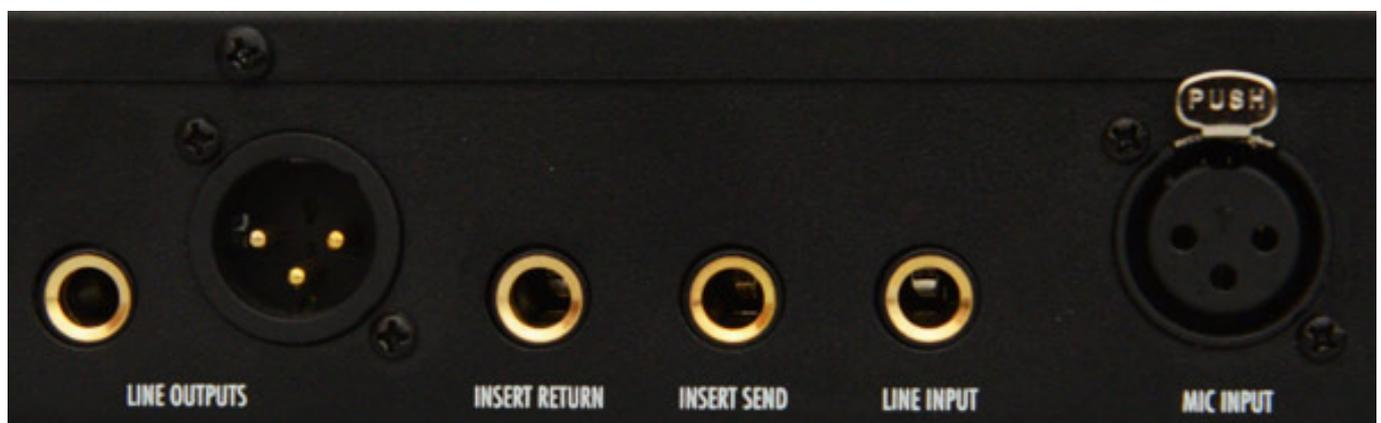
Ein echtes Highlight des WA73-EQ ist der rückseitig erreichbare und über das Panel schaltbare Insert über welchen sich beispielsweise ein Kompressor unmittelbar hinter Eingangsübertrager und Gain-Stufe in die Schaltung integrieren lässt. Ein nachgestellter Output-Level-Regler samt LED-Kette rundet das Setup ab und ergänzt den Channel um eine sinnvolle Fader-Funktion.
