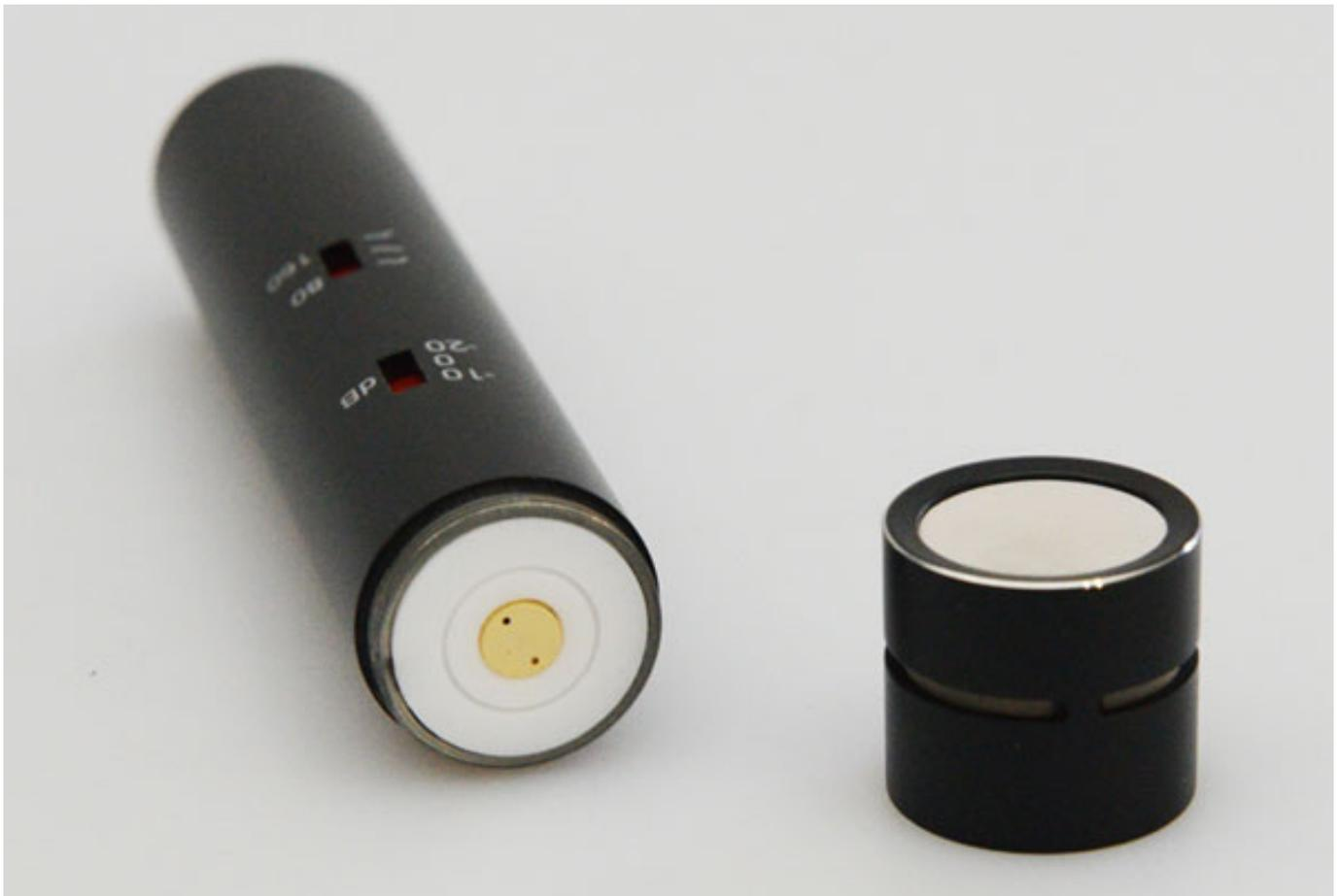
Bei dem hier vorgestellten sE 8 Pärchen handelt es sich um "echtes" Kondensatormikrofone, also kein Electret-Mikrofone mit fester Vorspannung. Die Kapseln mit einer 3  $\mu$ m starke, goldbedampfte Membrane werden in Handarbeit gefertigt. Laut dem von sE verfügt das sE8 über einen Übertragungsbereich von 20 Hz bis 20 kHz, mit einer leichten Anhebung bei etwa 7 kHz. Der Grenzschalldruck von 139 dB ist schon ziemlich ambitioniert und deutet auf eine gute Dynamik hin.
