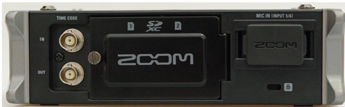
Auf der Rückseite sind linke Timecode-Ein- und Ausgang in Form von zwei BNC-Buchsen (s. Abb. oben) vorhanden.
