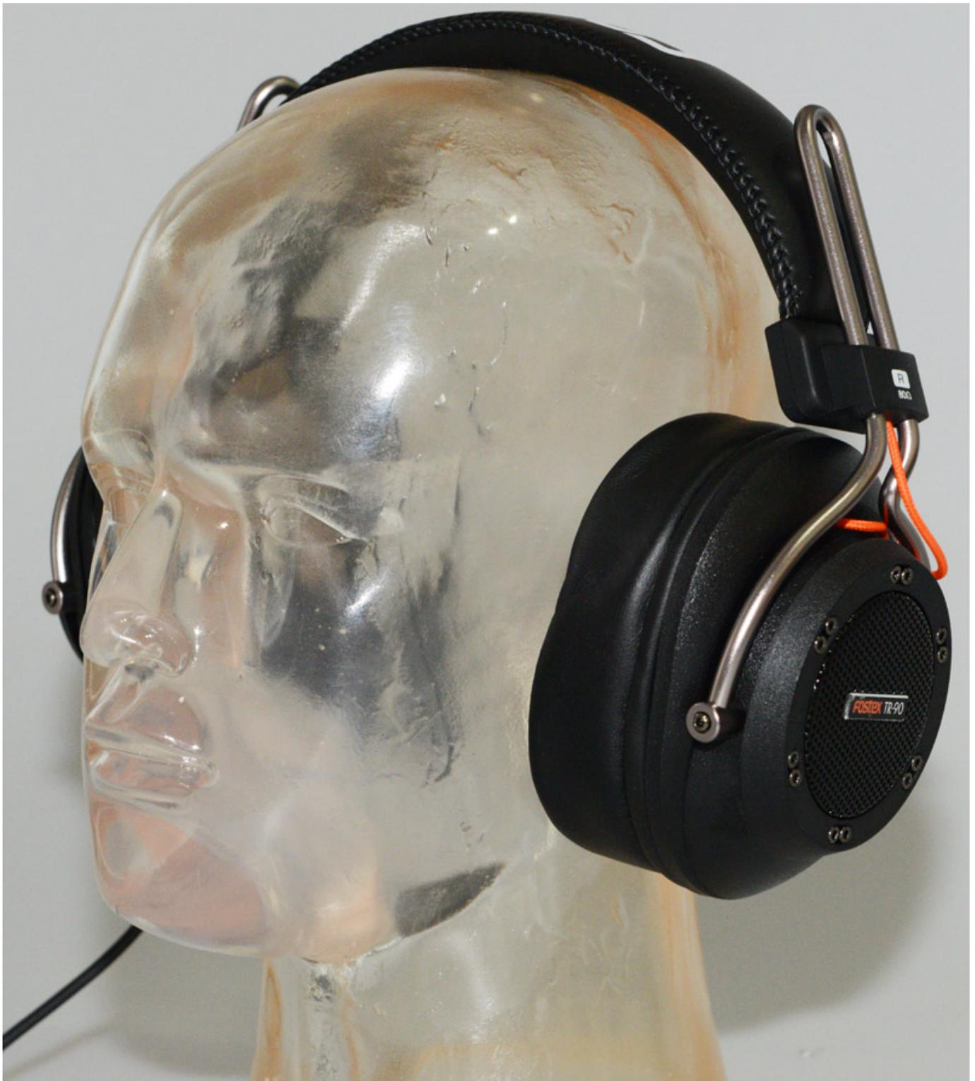
Der TR-90 ist ein halboffener Kopfhörer. Die Empfindlichkeit beträgt 90, bzw. 92 dB bei 1 kHz/1 mW. Frequenzgang und maximale Eingangsleistung wie bei den anderen beiden Modellen und das Gewicht beträgt 302 Gramm, bzw. 308 Gramm. Soviel zu den reinen Fakten.
