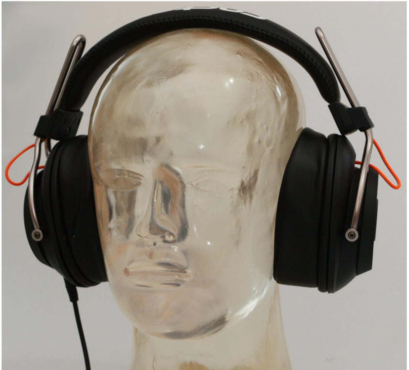
Der TR-70 ist als offener Kopfhörer konzipiert. Die Empfindlichkeit beträgt 93 dB bei 1 kHz/1 mW. Der Frequenzgang wird mit 5 Hz bis 35 kHz angegeben. Die maximale Eingangsleistung beträgt 100 mW. Das Gewicht beträgt bei der 80-Ohm-Version 298 Gramm und bei der 250-Ohm-Version, dank zusätzlichem Kupfer, 304 Gramm.
