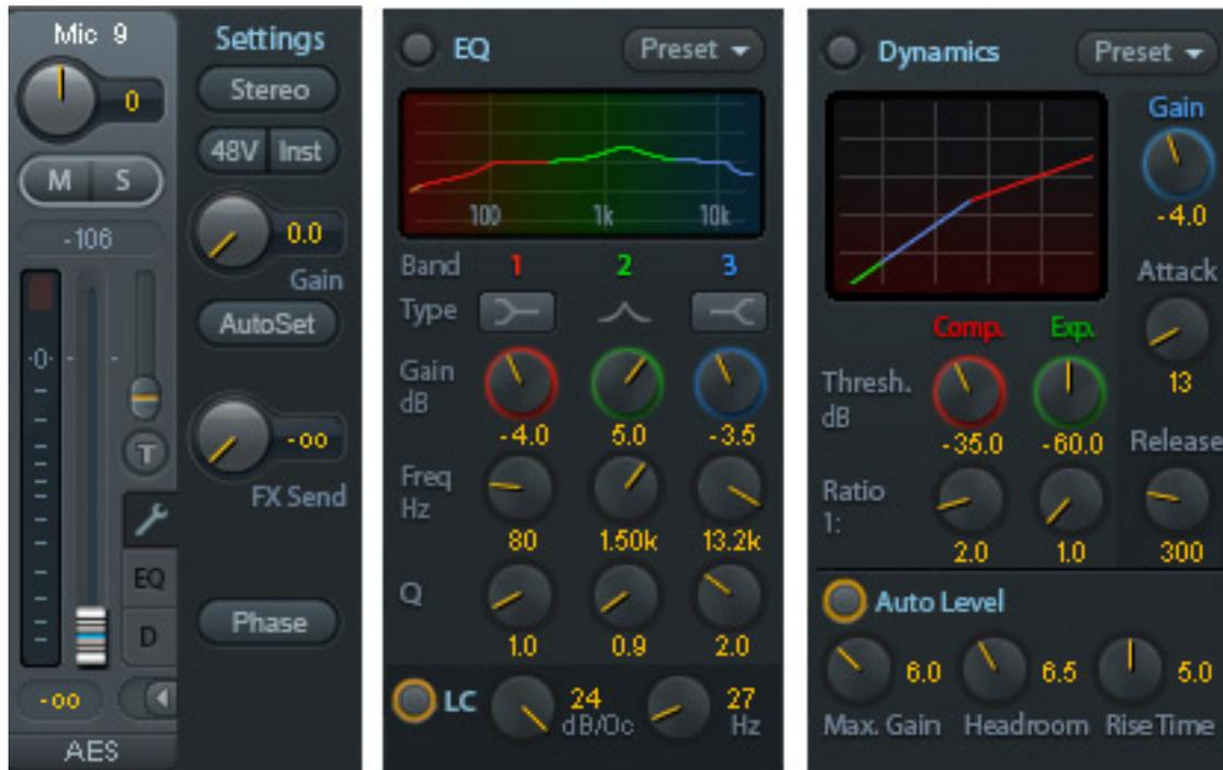
Über das Werkzeug-Icon kann man Einstellungen zu dem Kanal aufrufen. Bei den Eingangskanälen sind das z. B. Mic/Instrument-Umschaltung, Stereopaarung, Phantomspeisung, Gain und AutoSet, Effekt-Send-Pegel sowie Phasendrehung. An jedem Hardware-Eingangs- und Ausgangskanal steht auch jeweils ein Equalizer und ein Kompressor zur Verfügung (s. Abb. oben). Diese werden, wie die Pegel, im DSP des Interface gerechnet.
