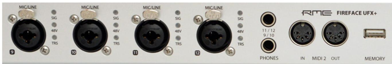
MIDI-I/O-Schnittstellen befinden sich wie beim UFX sowohl hinten auf der Rückseite, als auch auf der Gerätefront. Die Gerätefront (s. Abb. oben) ist auch leicht überarbeitet worden. So sind die kleinen Griffe weggefallen, die Frontplatte hat nun Alu-Farbe und die LEDs sind etwas anders angeordnet. Auf der Front befinden sich die vier MIC/LINE-Eingänge. Hier ist noch zu erwähnen, dass die Eingänge nun nicht mehr über ein Pad/Abschwächer verfügen, da der Dynamikumfang erhöht wurde
